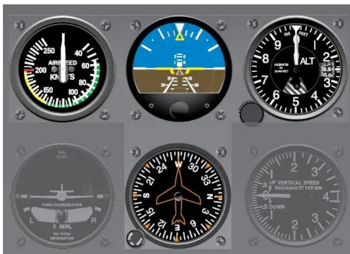
Obr. 6 Rozmiestnenie prístrojov do „T“ vid' Hareide a Ostnes [17]
