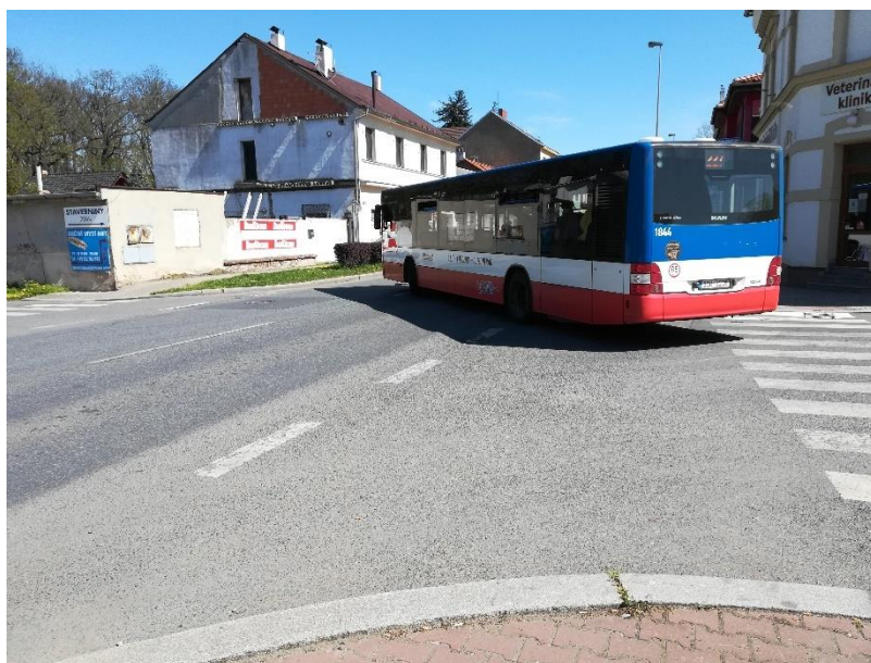
Obrázek 8 – Vybočení autobusu ze směru Nádraží Uhřetěves do protisměru na křižovatce Přátelství x Lidického
