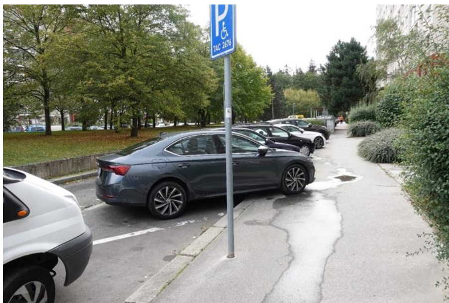
Obrázek 21 - Nutnost částečného stání na chodníku z důvodu neadekvátních rozměrů parkovacího stání [24].
