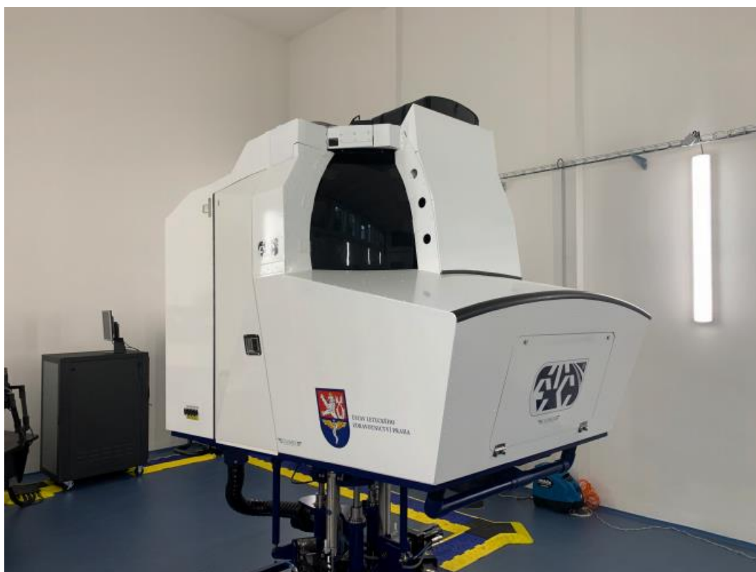
Obrázek 15: Dezorientační simulátor Gyro IPT II.
