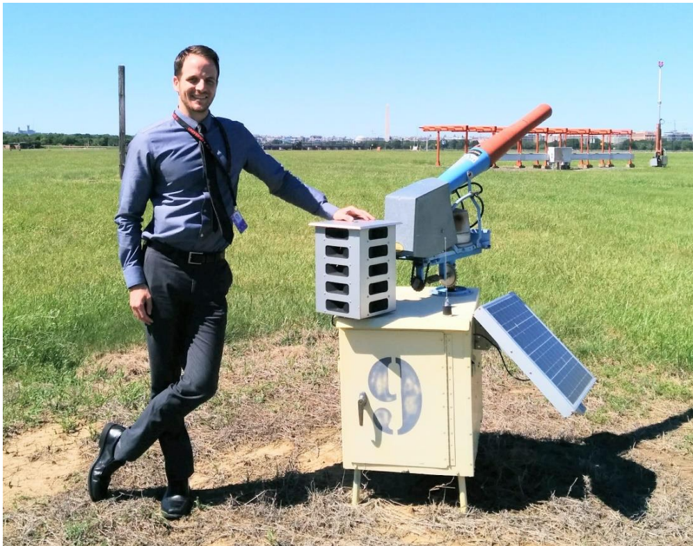
Obrázek 12 – Plynové dělo používané na letišti Ronalda Reagana ve Washingtonu [33]
