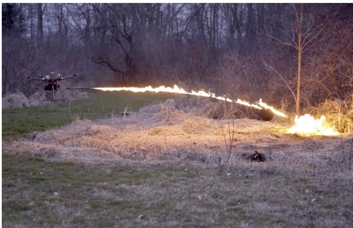
Obrázek 16 – Dron značky DJI s modulem TF-19 WASP [44]
