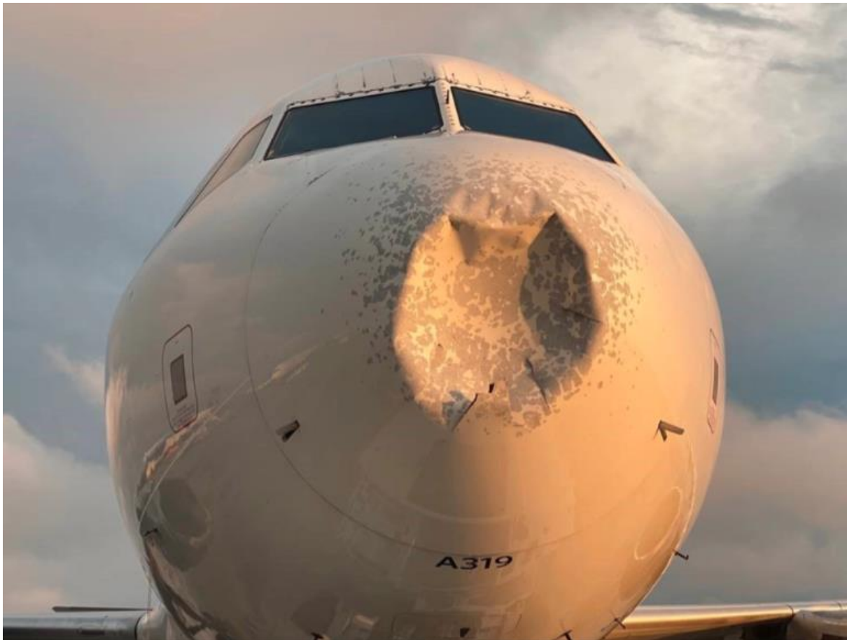
Obrázek 1 – Airbus A319 po čelní srážce ptákem [13]
