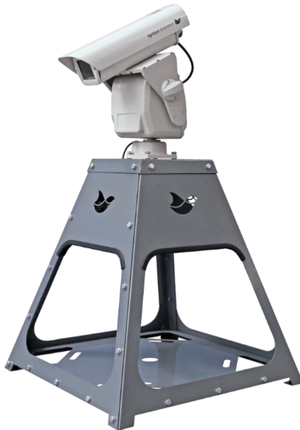
Obrázek 14 – Automatizovaný systém používající laser k plašení ptactva [35]
