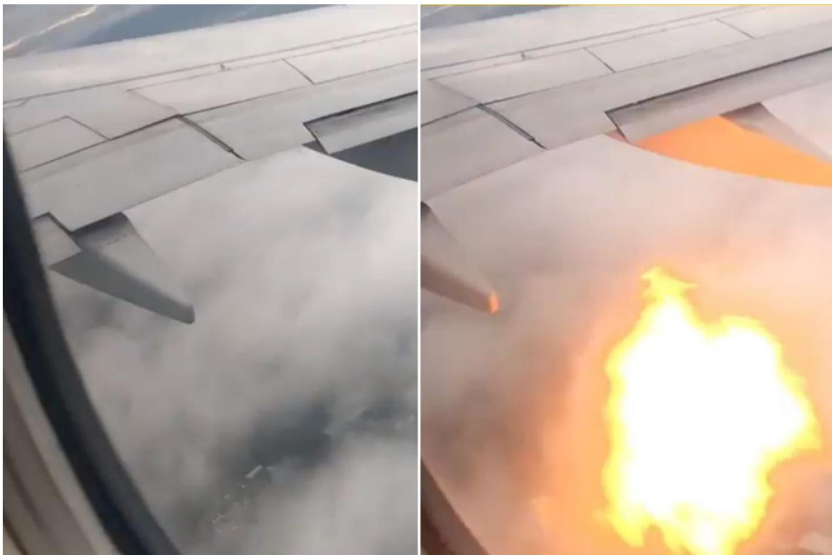
Obrázek 2 – Pumpáž proudového motoru po nasátí ptáka do motoru [12]
