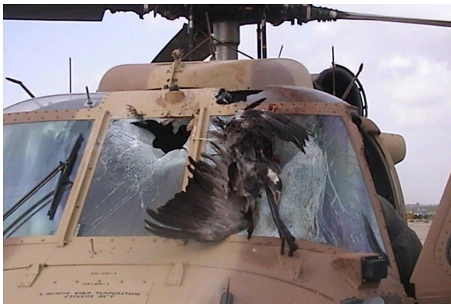
Obrázek 3 – Čelní sklo vrtulníku Sikorsky UH-60 Black Hawk po srážce s jeřábem [17]
