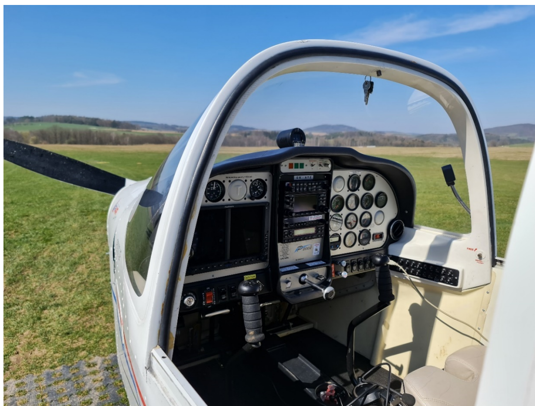
Obrázek 2.3 palubní deska letadla Tecnam P2002JF. Na levé straně před sedačkou pilota je na palubní desce Garmin G500 a na prostředku palubní desky je pak Garmin GNS400W společně s panely pro nastavení rádia a odpovídače módu S.
