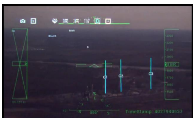
Obrázek 12: Modré obrysy tří překážek v pravé části na HMD. (Zdroj: Aeroglass)
