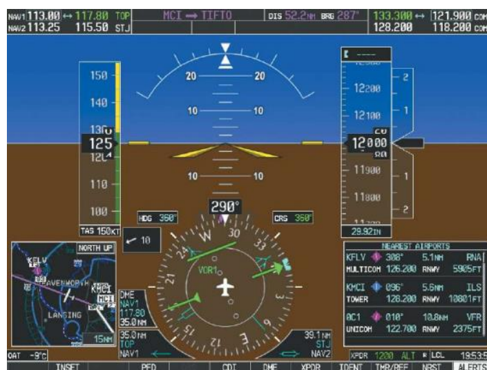
Obrázek 11: Moderní integrovaný přístrojový panel Garmin G1000 (Zdroj: Garmin G1000 Pilot's Guide for Cessna Nav III).
