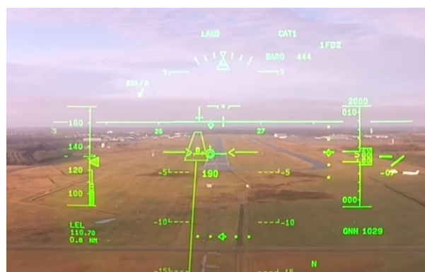
Obrázek 13: Zvýrazněný obrys dráhy s prodlouženou osou na HUD v Airbusu A319. Obrys se na obrázku jeví vůči dráze posunutý kvůli poloze kamery. (Zdroj: Youtube)
