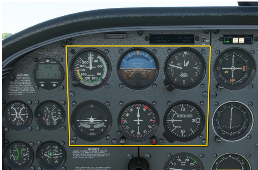
Obrázek 10: Žlutý rámeček vyznačuje základní přístroje "basic six" v letounu Cessna 172 (Zdroj: Microsoft Flight Simulator)
