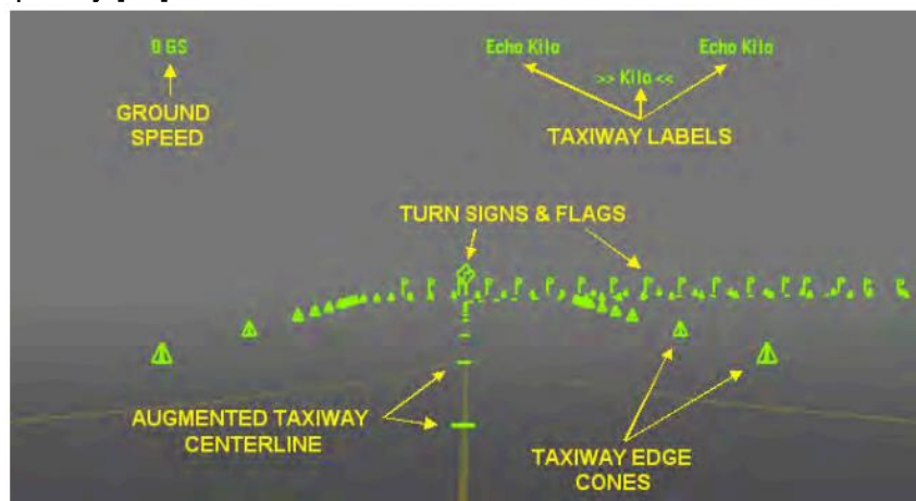
Obrázek 14: T-NASA HUD symbologie rozšířené reality v mlžném prostředí letištních pojezdových ploch při nízké dohlednosti.
