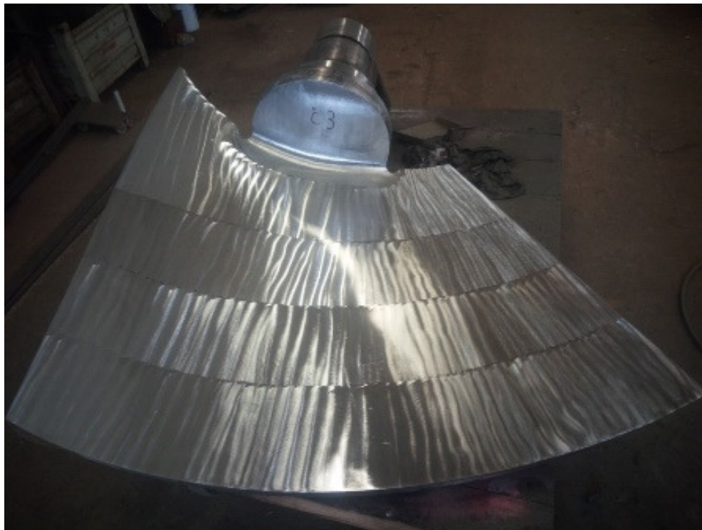
Obr. č. 76 OL č.3 po finálním přebroušení
