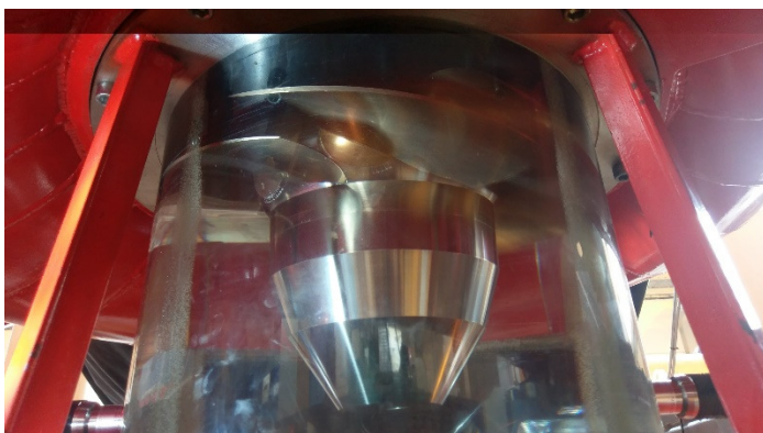
Obr. č. 41 Modelové zkoušky OK TG3 elektrárny Slapy (2018) z výzkumného ústavu ČKD Blansko engineering, a.s.,
