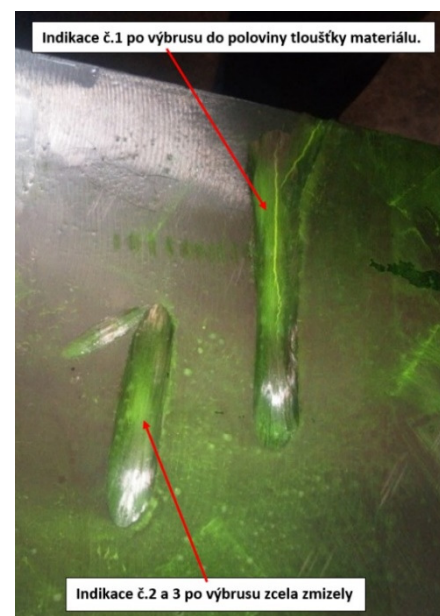
Obr. č. 71 MT kontrola po částečném výbrusu indikací na OL 3
