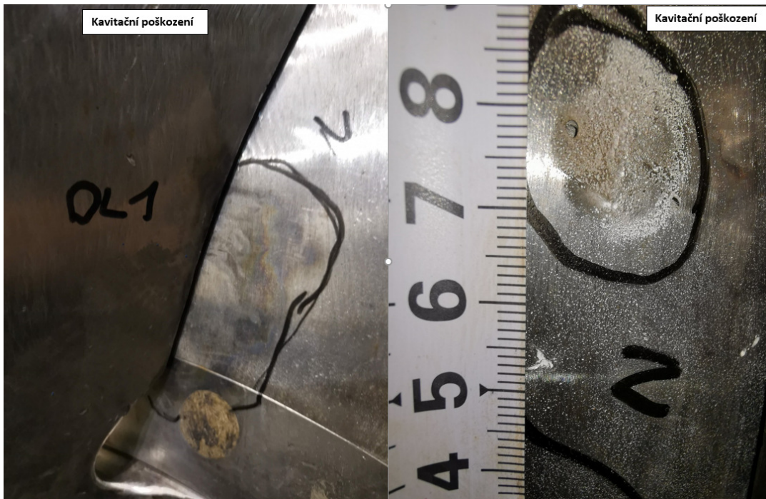
Obr. č. 49 Kavítace na náboji OK 1. část
