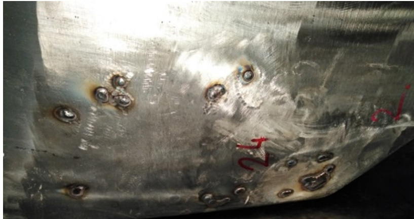
Obr. č. 75 Oprava kavitace EOR TG2
