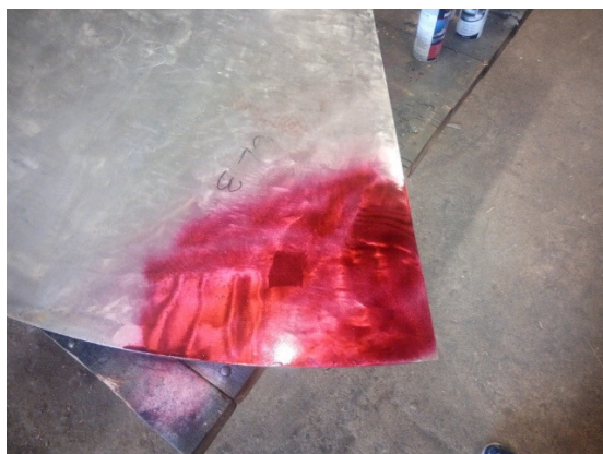
Obr. č. 74 Kontrola PT po opravě
