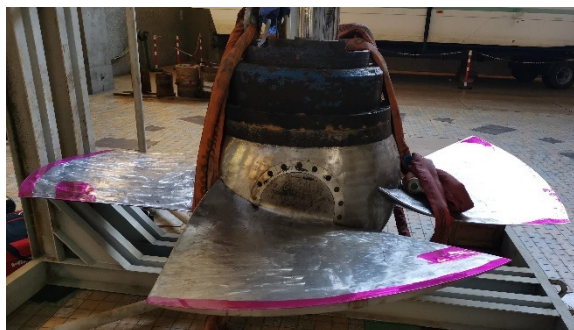
Obr. č. 66 Nanesení kontrastéru na OL
