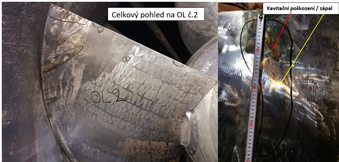
Obr. č. 52 Celkový pohled na OL č. 2 / Kavitační poškození na tlakové straně OL
