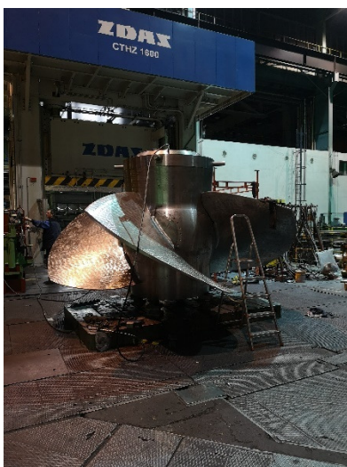
Obr. č. 21 Tlaková zkouška OK elektrárny EKA
