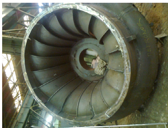
Obr. č. 12 Odlitek OK elektrárny ELI I
