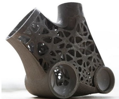
Obrázek 10: Dílec vyrobený technologií Selective Laser Sintering (19)
