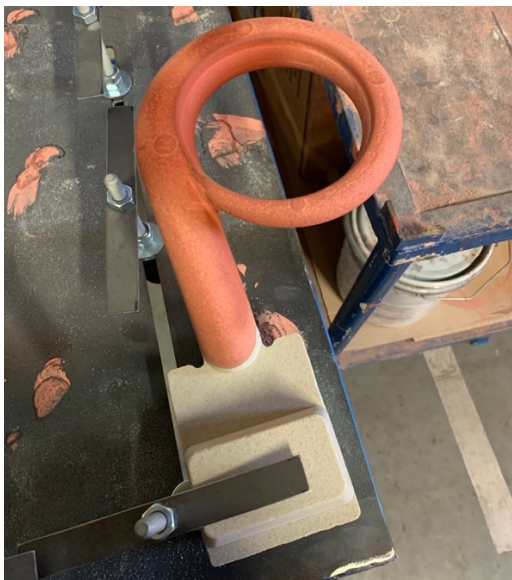
Obrázek 30 - Nátěr na jádrech
