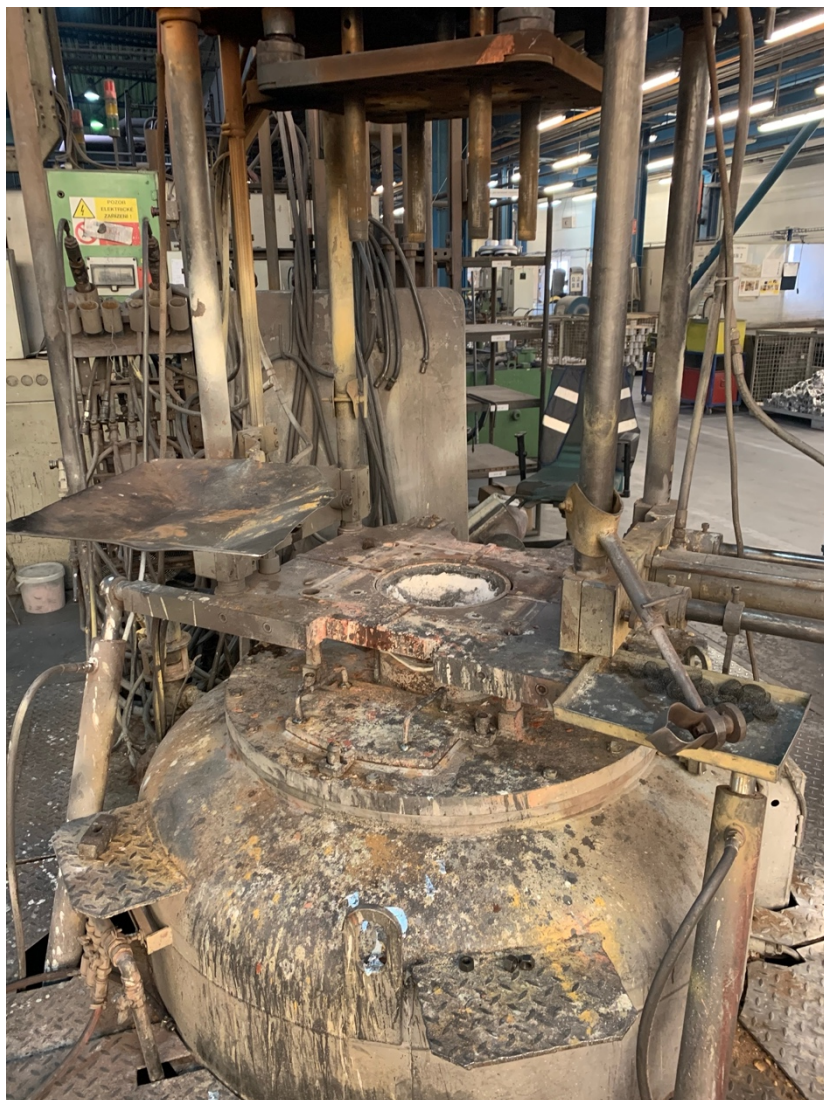
Příloha 6. Nízkotlaká lící pec 2. generace bez nasazené formy
