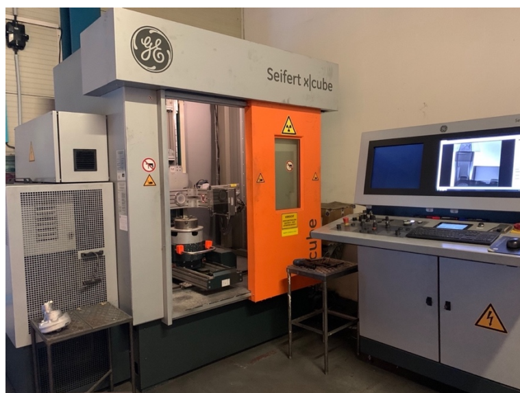
Obrázek 14 - Seifert x|cube series nedestruktivní testování odlitků
