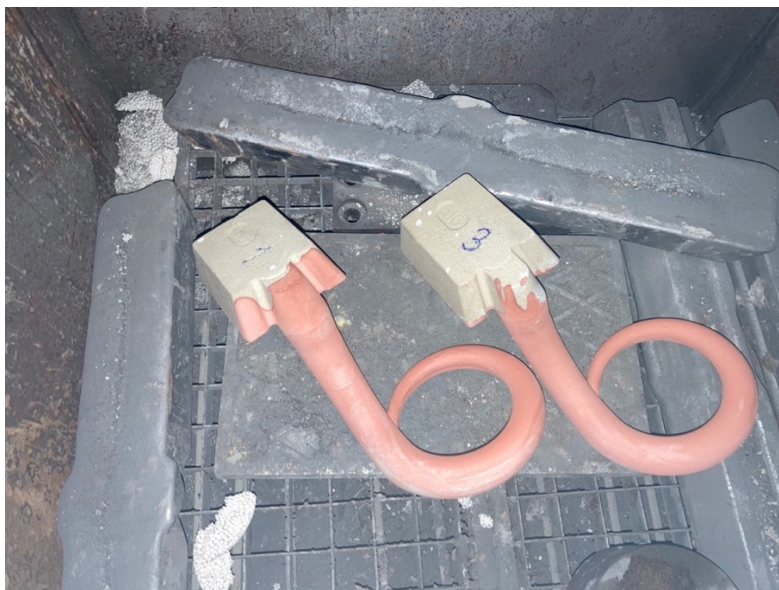
Obrázek 34 - Umístění přehřátých jader v peci
