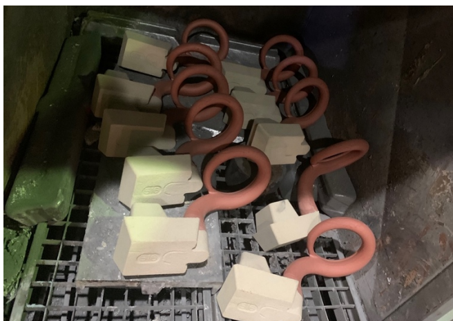
Obrázek 42 - Umístění jader v předehřívací peci
