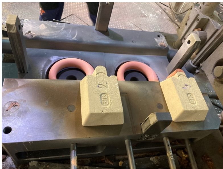
Obrázek 35 - Odlévací proces standardních jader
