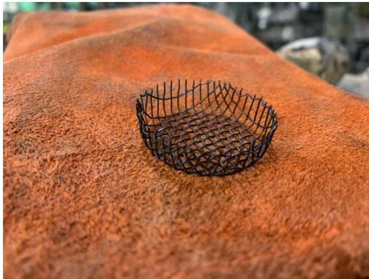
Obrázek 12 - Kovový filtr používaný ve slévárně Beneš a Lát a.s.
