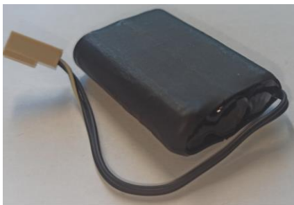
Obrázek 34: Baterie pro měřící karty aparatury EHL
