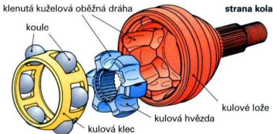
Obrázek 5: Kloub Rzeppa bez axiálního posuvu [11]
