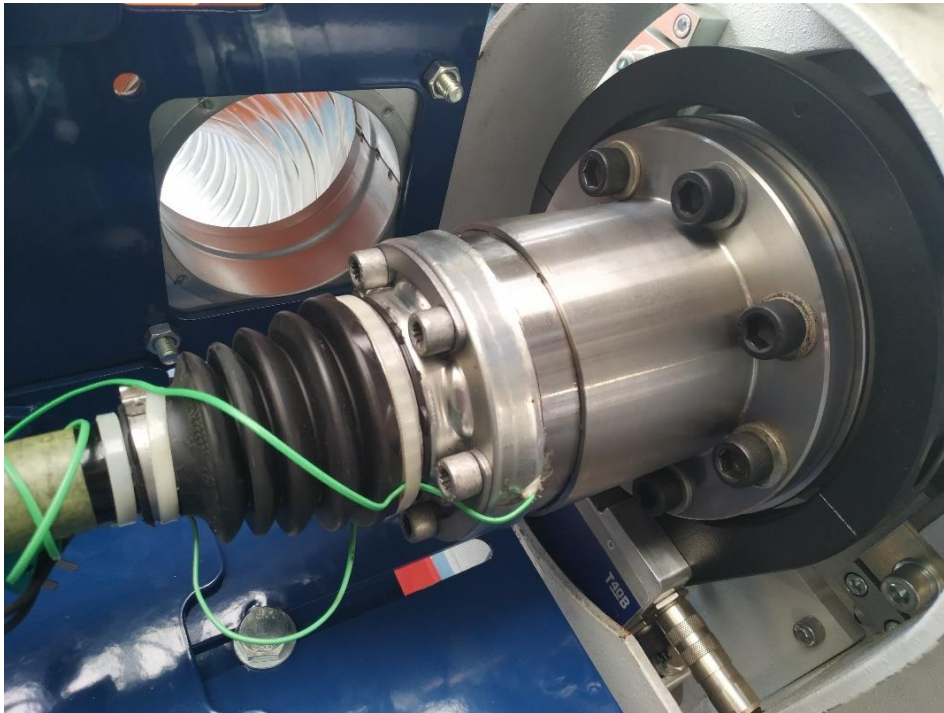
Obrázek 69: Propojení kloubového hřídele – strana rozvodovka
