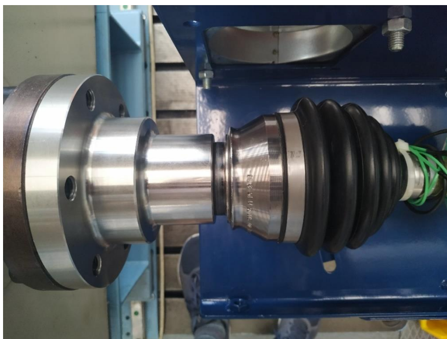
Obrázek 85: Propojení kloubového hřídele – strana pneumatika
