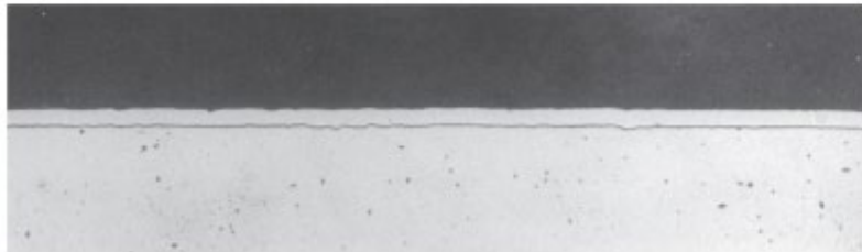
Obrázek 28 Řez galvanicky naneseným povlakem zinku [44]
