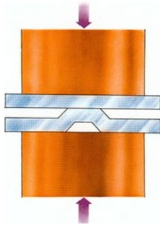
Obrázek 6 Schéma výstupkového odporového svařování [14]
