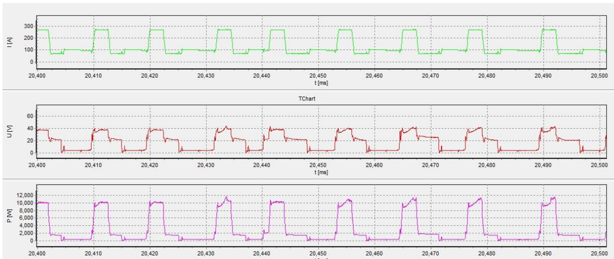
Obr. 34 Časový záznam svařovacího proudu a napětí a výkonu oblouku ( I=140\text{ A} )
