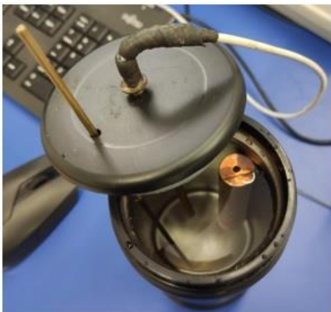
Obr. 25 Uspořádání kalorimetru a použité vzorky k měření měrné tepelné kapacity
