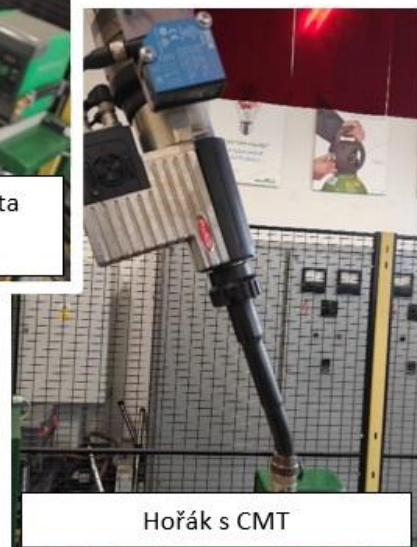
Obr. 27 Reálné uspořádání kalorimetrického měření svařovacího procesu
