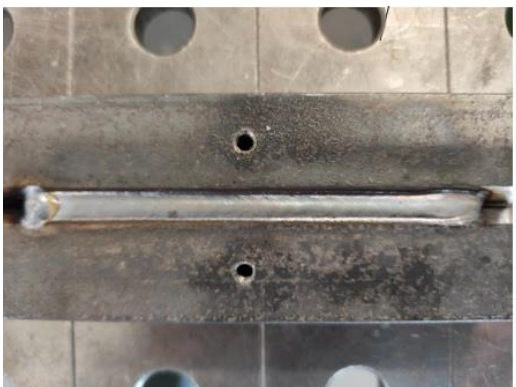
Obr. 44 Svařování metodou CMT do V-drážky (hloubka = 5,5mm, délka hrany zaplněná svarovým kovem 11,5mm, měřítko makro snímku = 1000 \mu m, Nital 2%)
