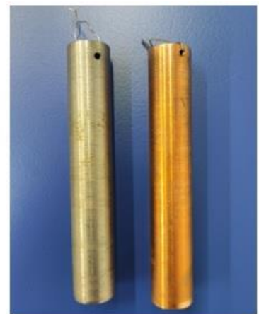
Obr. 25 Uspořádání kalorimetru a použité vzorky k měření měrné tepelné kapacity
