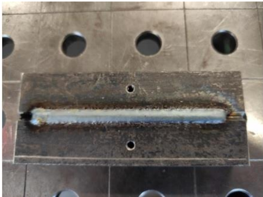
Obr. 43 Svařování metodou CMT do V-drážky (hloubka = 3,5mm, délka hrany zaplněná svarovým kovem 9,25mm, měřítko makro snímku = 1000 \mu m, Nital 2%)
