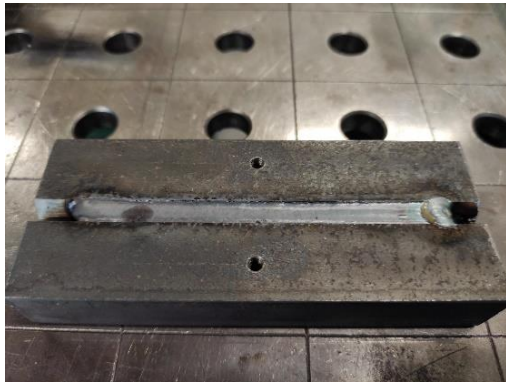
Obr. 45 Svařování metodou CMT do V-drážky (hloubka = 6,5mm, délka hrany zaplněná svarovým kovem 12 mm, měřítko makro snímku = 1000 \mu m, Nital 2% )
