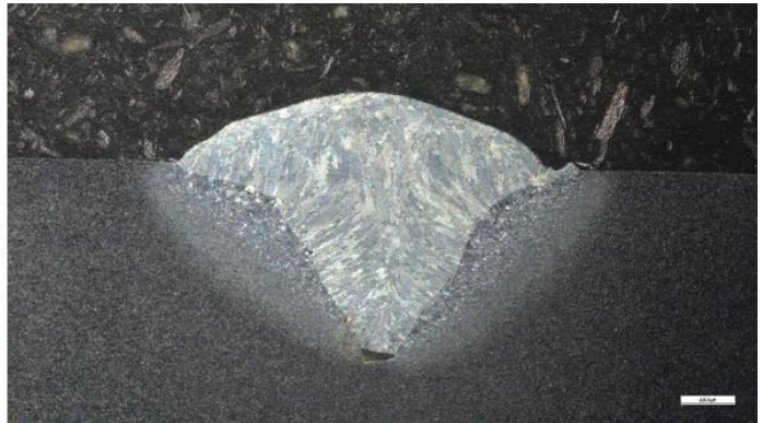
Obr. 43 Svařování metodou CMT do V-drážky (hloubka = 3,5mm, délka hrany zaplněná svarovým kovem 9,25mm, měřítko makro snímku = 1000 \mu m, Nital 2%)
