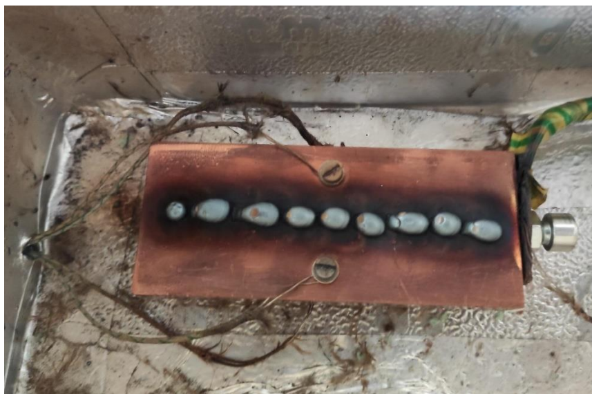
Obr. 40 Nesouvislý návar na měděném vzorku ( I=140 A)
