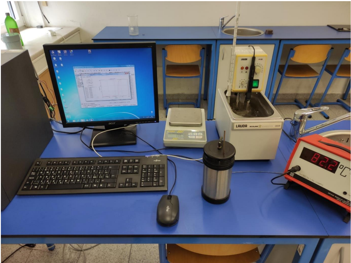
Obr. 24 Uspořádání experimentu při měření měrné tepelné kapacity
