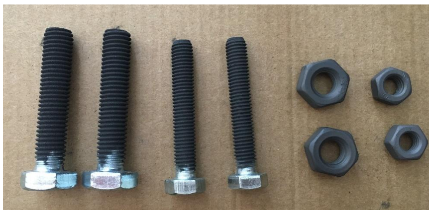
Obr. 28: Šrouby a matice opatřené kluzným lakem
