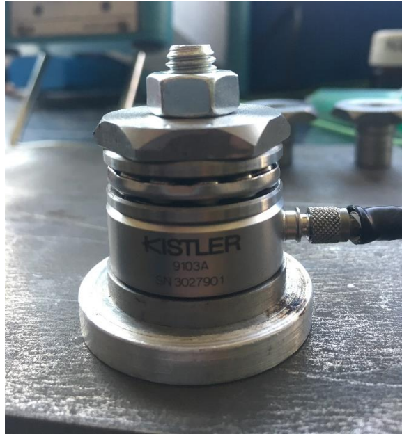
Obr. 21: Zkušební zařízení na určení vlivu tření v závitu
