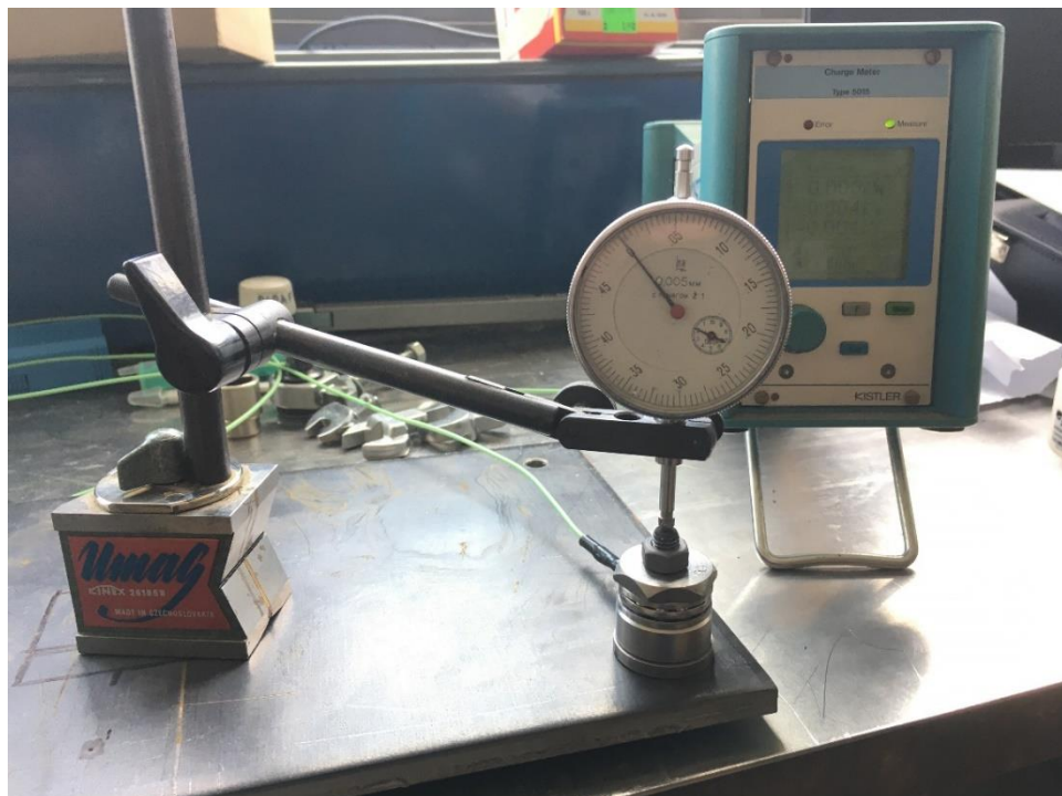
Obr. 22: Připravený testovaný vzorek včetně měření prodloužení
