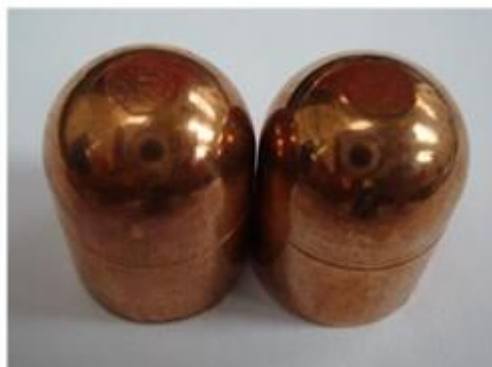
Obr. 36 Výkres elektrodové čepičky typ 39D 1978-2, \varnothing 5 mm [51]
