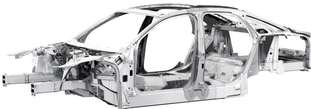
Obr. 22 Rámová karoserie Audi A8 1. generace, 1994 [36]
