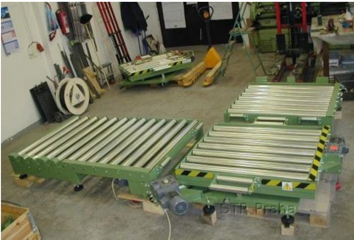
Obr. 25.: Rám (nosná konstrukce) válečkového dopravníku svařená z L profilů a točna (uprostřed). [STR Praha s.r.o.]
