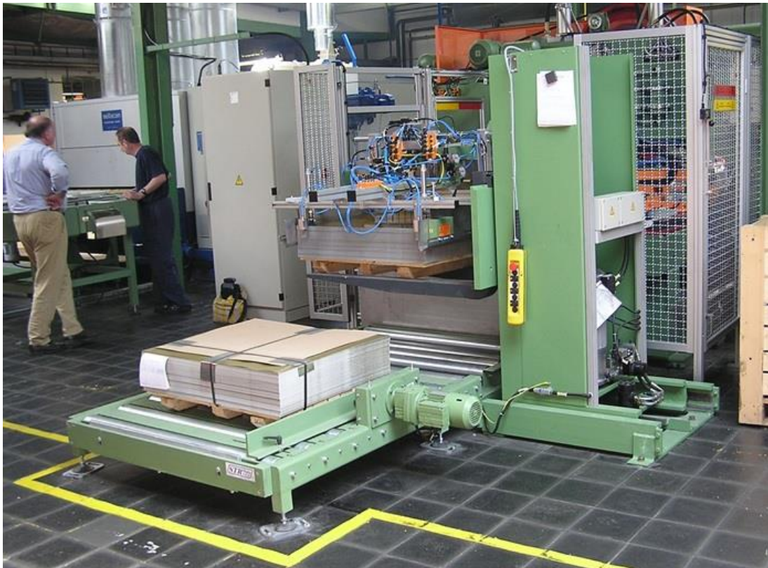
Obr. 81.: Současné konstrukční řešení poháněné válečkové dráhy s paletou naloženou balením pocínovaného plechu před lisem P25. [STR Praha s.r.o.]
