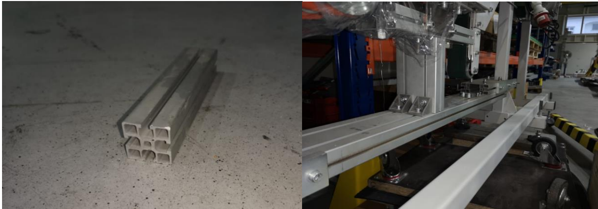
Obr. 24.: Hliníkový profil (vlevo) a část hliníkové konstrukce válečkové dopravní dráhy. [autor]
