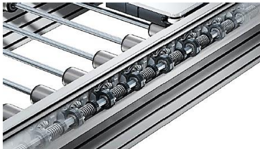
Obr. 47.: Pohon transmisní hřídelí s tvarovým stykem. [20]
