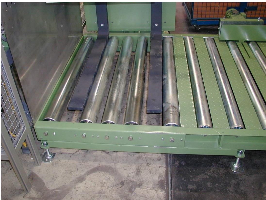
Obr. 1.: Současné konstrukční řešení poháněné válečkové dráhy s paletou naloženou balením pocínovaného plechu před lisem P25 (nahore) a podávací mechanismus lisu P25 (dole). [STR Praha s.r.o.]
