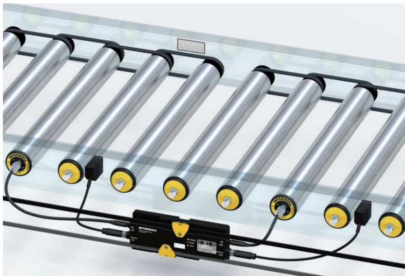
Obr. 48.: Válečky s integrovaným pohonem (řídící systém RollerDrive - Interroll). [40]
