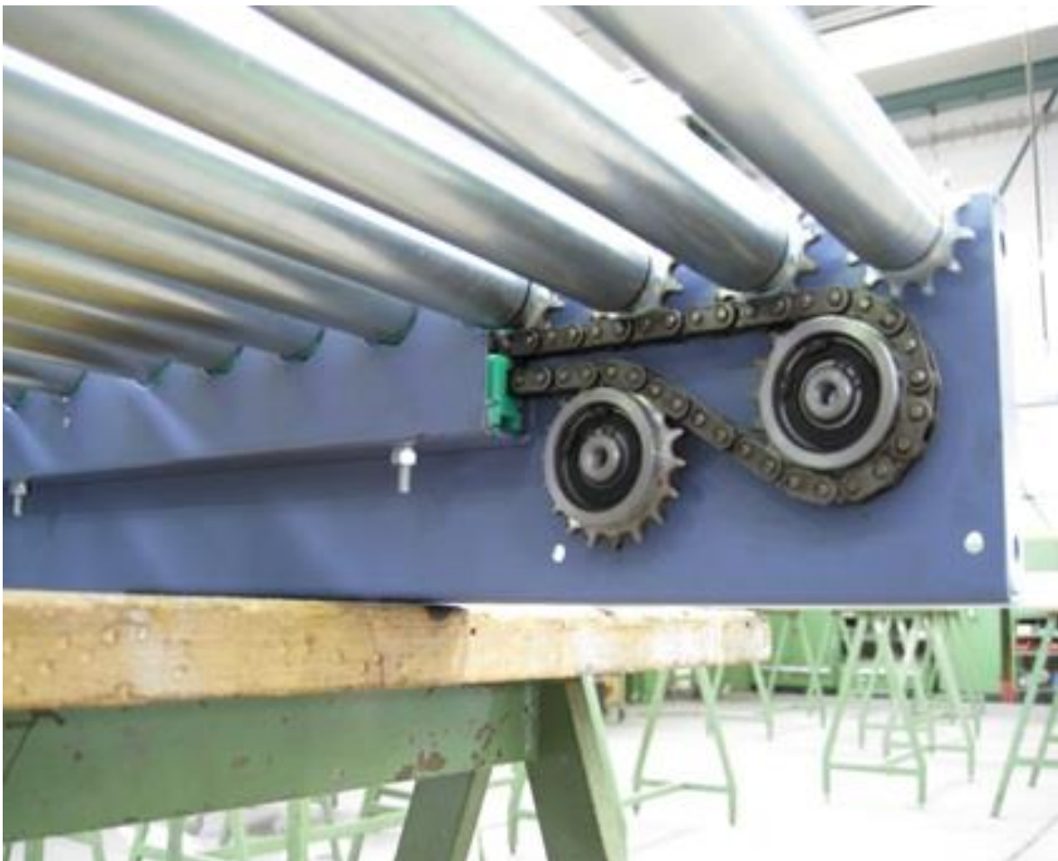
Obr. 44.: Tečný pohon válečků řetězem. [39]
