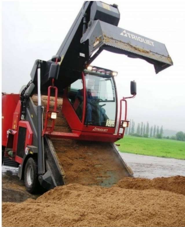
Obr. 9.: Bezezbytkové nakládání s přihrnovacím štítem samojízdného MKV.[3]
