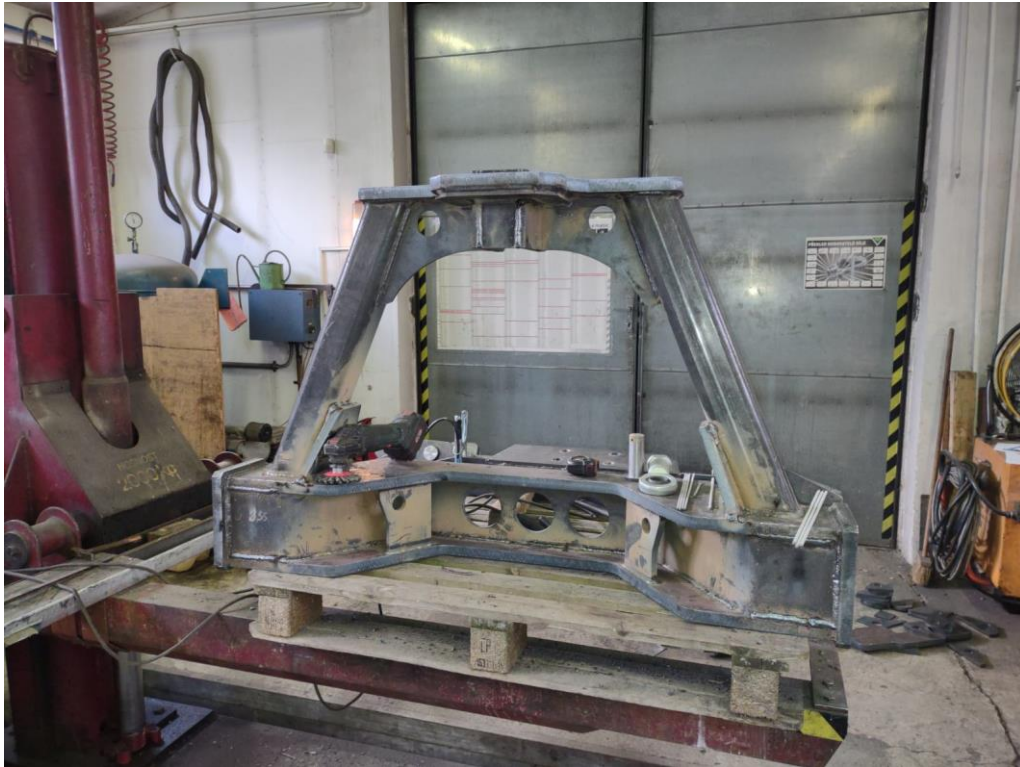
Obr. 93: Vnitřní rám dynamometru během výroby
