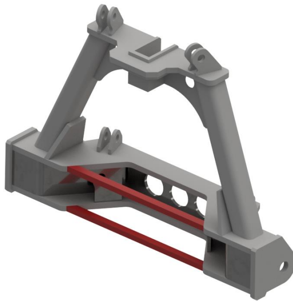
Obr. 89: Doplňené výztuhy na vnitřním rámu
