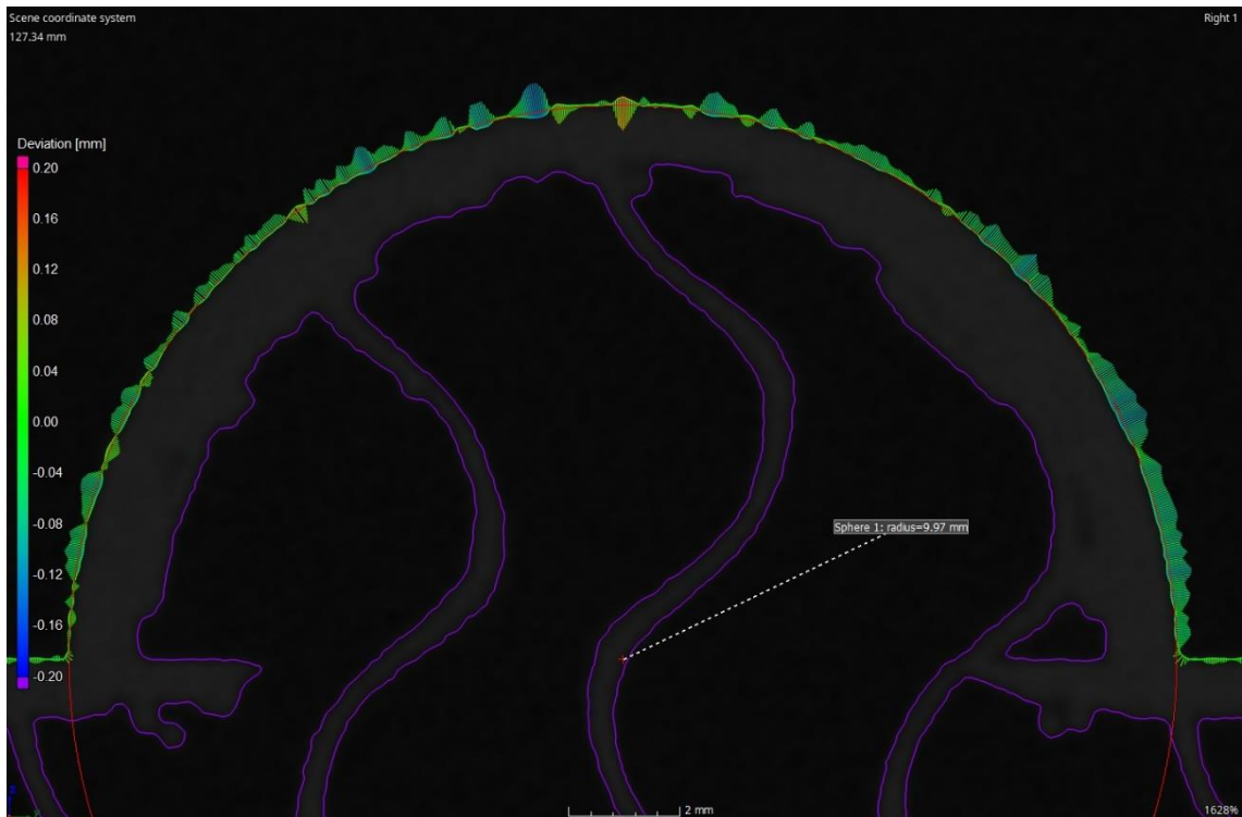
Obrázek 33 - Ukázka měření artefaktu verze 3 od MK3S+ PLA (analýza polokoule)
