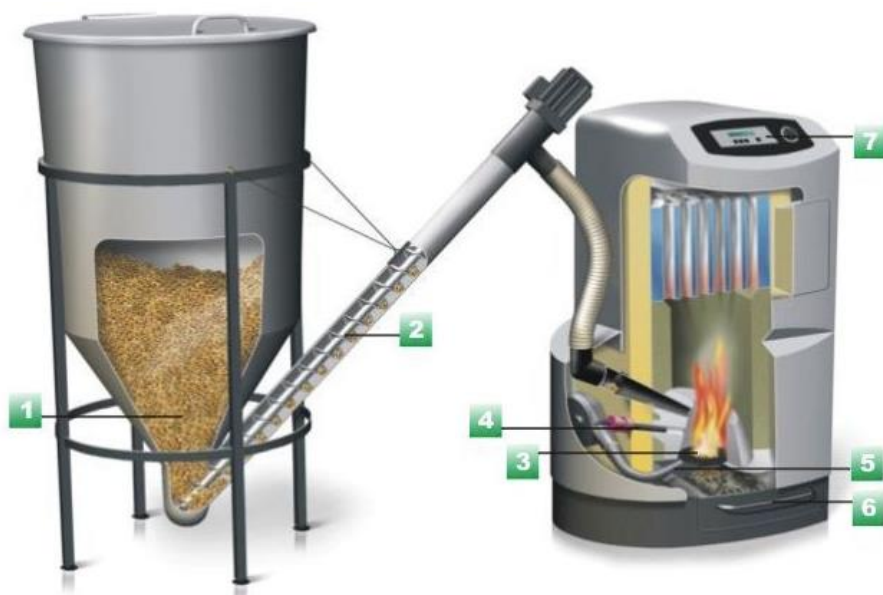
Obr. 6 - Kotel na biomasu se samočinnou dodávkou paliva [7]
