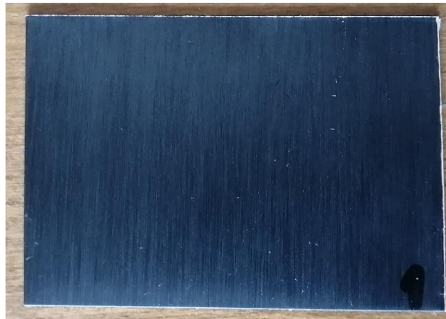
Obr. 26: Černý elox před měřením [foto autora]
