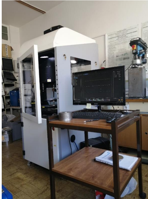
Obr. 17: Tribometr MFT-5000 propojený s počítačem [foto autora]
