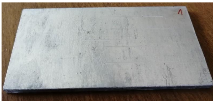
Obr. 23: Deska s žárovým zinkem po měření [foto autora]
