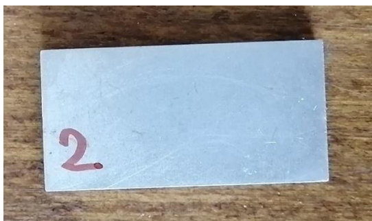
Obr. 20: Vzorek s galvanickým zinkem před měřením [foto autora]
