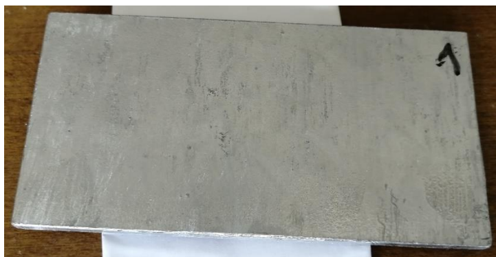
Obr. 22: Deska s žárovým zinkem před měřením [foto autora]
