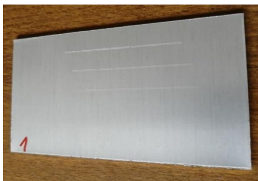
Obr. 25: Stříbrný elox po měření [foto autora]
