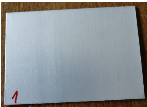
Obr. 24: Stříbrný elox před měřením [foto autora]
