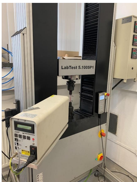
Obrázek 34- Použitý trhačí stroj (vlastní archiv)
