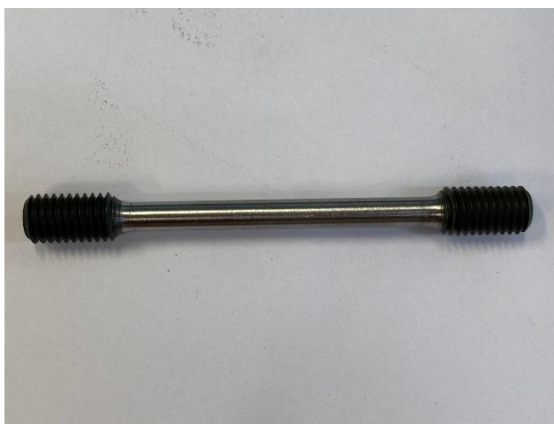
Obrázek 37- Fotka zkušební tyče pro zkoušku tahem (vlastní archiv)
