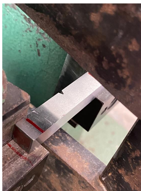
Obrázek 48- Detail nastavení vzorku (vlastní archiv)
