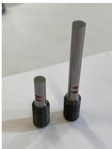
Obrázek 41- Přetržený vzorek V2 (vlastní archiv)
