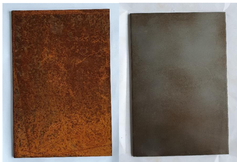
Obrázek 23: Vzorek před a po otryskání (Corten A)
