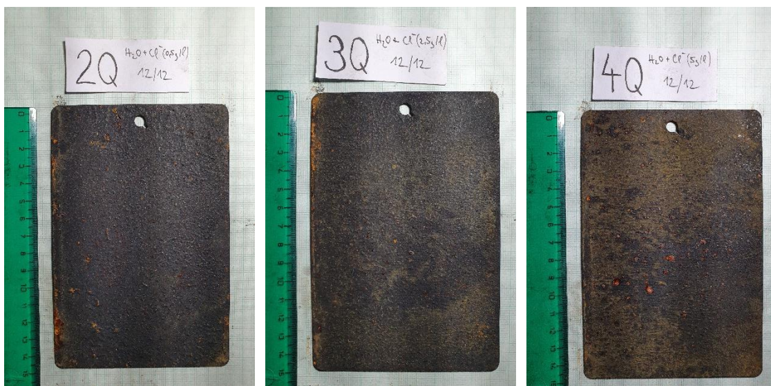
Obrázek C: Vzorčky po 500 hodinách expozice
