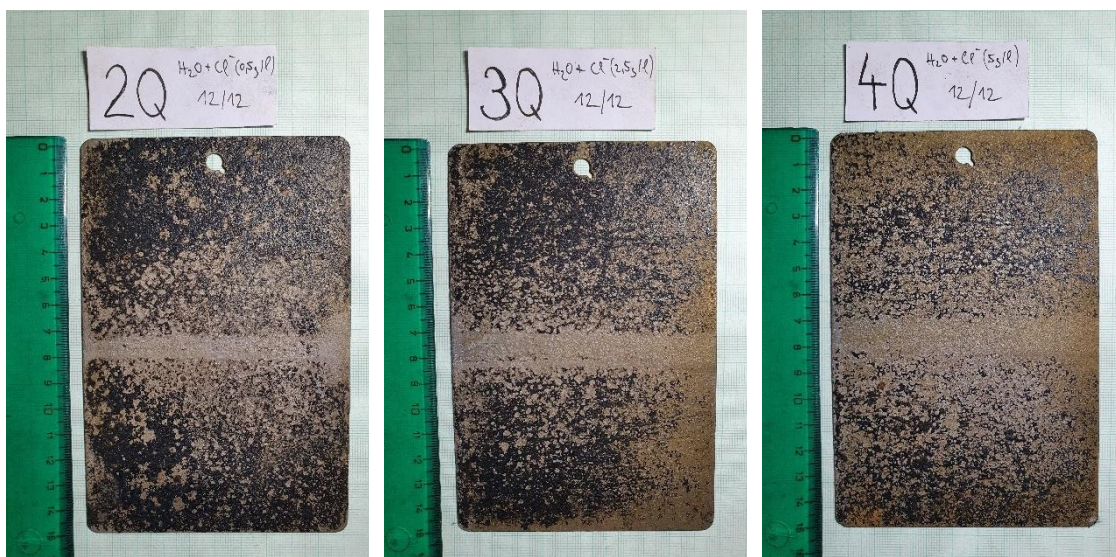
Obrázek E: Vzorčky po odstranění koroze
