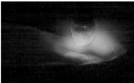
Obrázek 28 Zkratový přenos, odtavování kapky kovu, WFS = 5,5 m/min, TS = 47 cm/min
