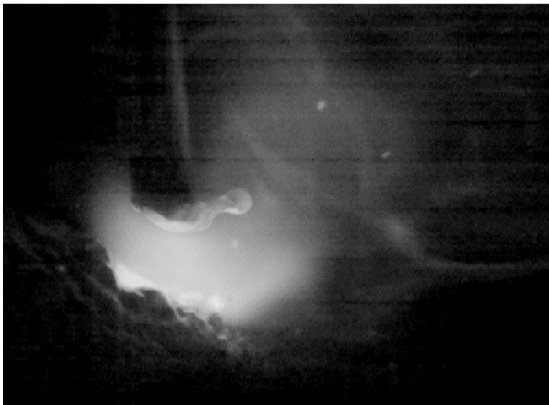
Obrázek 38 Zkratový přenos, plyn uvolňující se do okolí, WFS = 2,5 m/min, TS = 21,4 cm/min
