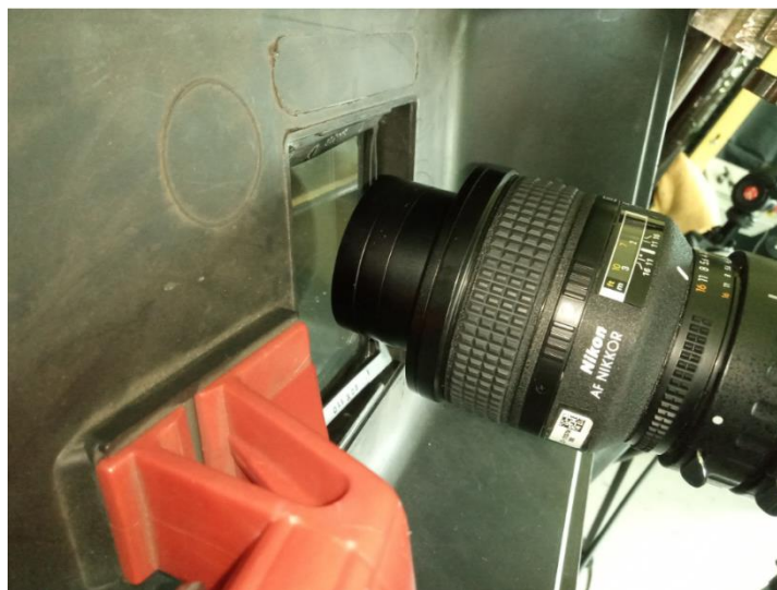
Obrázek 23 Kryt, filtry a objektiv kamery (AF-S Micro NIKKOR 60 mm F/2.8G ED, Nikon)
