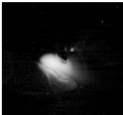
Obrázek 37 Zkratový přenos, rozstřík, WFS = 2,5 m/min, TS = 21,4 cm/min
