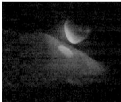
Obrázek 47 IAC, odtavování kapky kovu, WFS = 3,3 m/min, TS = 28,2 cm/min
