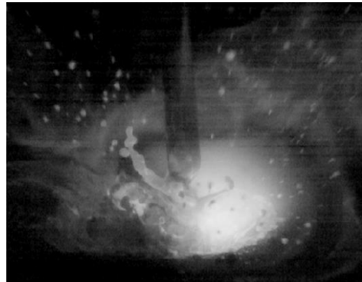
Obrázek 39 Zkratový přenos, plyn uvolňující se do okolí, WFS = 9,1 m/min, TS = 70 cm/min
