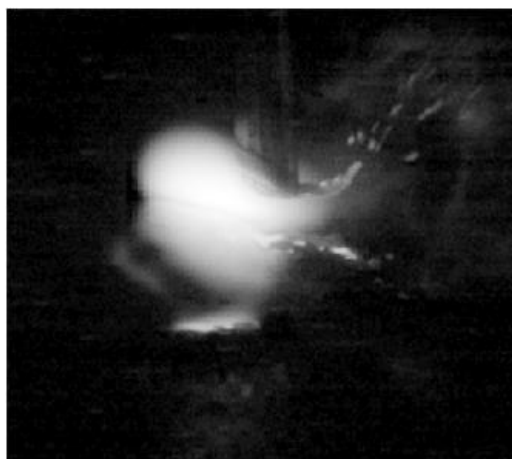
Obrázek 35 Zkratový přenos, moment po oddělení kapky do svarové lázně, WFS = 3,3 m/min, TS = 28,2 cm/min
