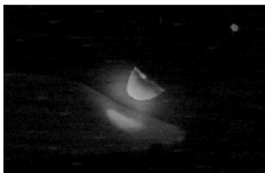
Obrázek 27 Zkratový přenos, odtavování kapky kovu WFS = 3,3 m/min, TS = 28,2 cm/min
