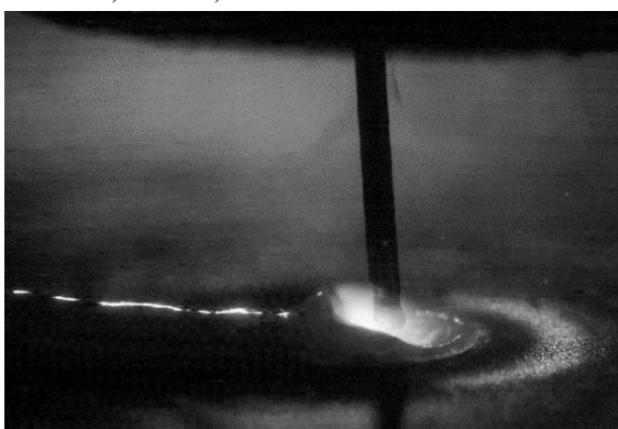
Obrázek 44 Zkratový přenos, odtavování kapky kovu, laser, WFS = 9,1 m/min, TS = 70 cm/min
