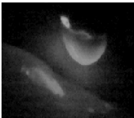
Obrázek 49 IAC, odtavování kapky kovu, elektrický oblouk, WFS = 2,5 m/min, TS = 21,4 cm/min
