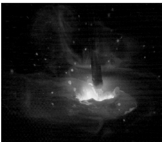
Obrázek 36 Zkratový přenos, rozstřík, WFS = 9,1 m/min, TS = 70 cm/min
