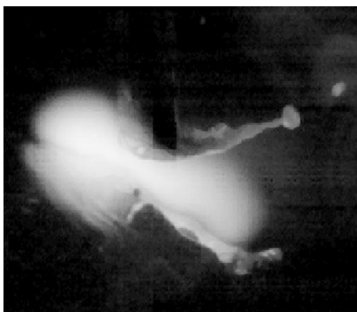
Obrázek 51 Zkratový přenos, moment po oddělení kapky do svarové lázně, WFS = 2,5 m/min, TS = 21,4 cm/min
