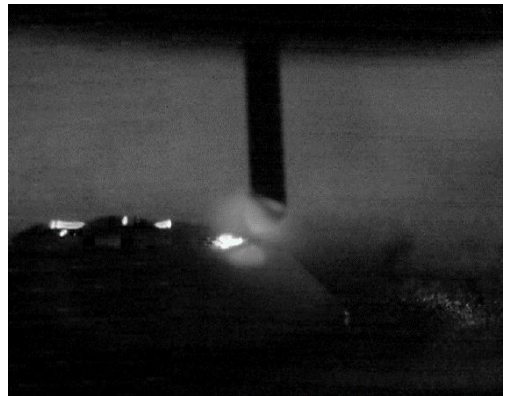
Obrázek 41 Zkratový přenos, odtavování kapky kovu, laser, WFS = 3,3 m/min, TS = 28,2 cm/min
