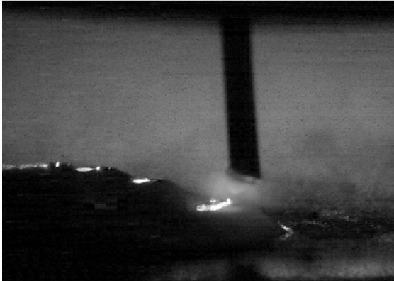
Obrázek 40 Zkratový přenos, odtavování kapky kovu, laser, WFS = 2,5 m/min, TS = 21,4 cm/min
