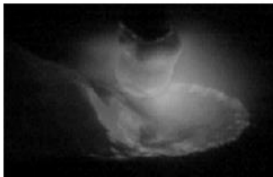
Obrázek 29 Zkratový přenos, odtavování kapky kovu, WFS = 7 m/min, TS = 59,4 cm/min
