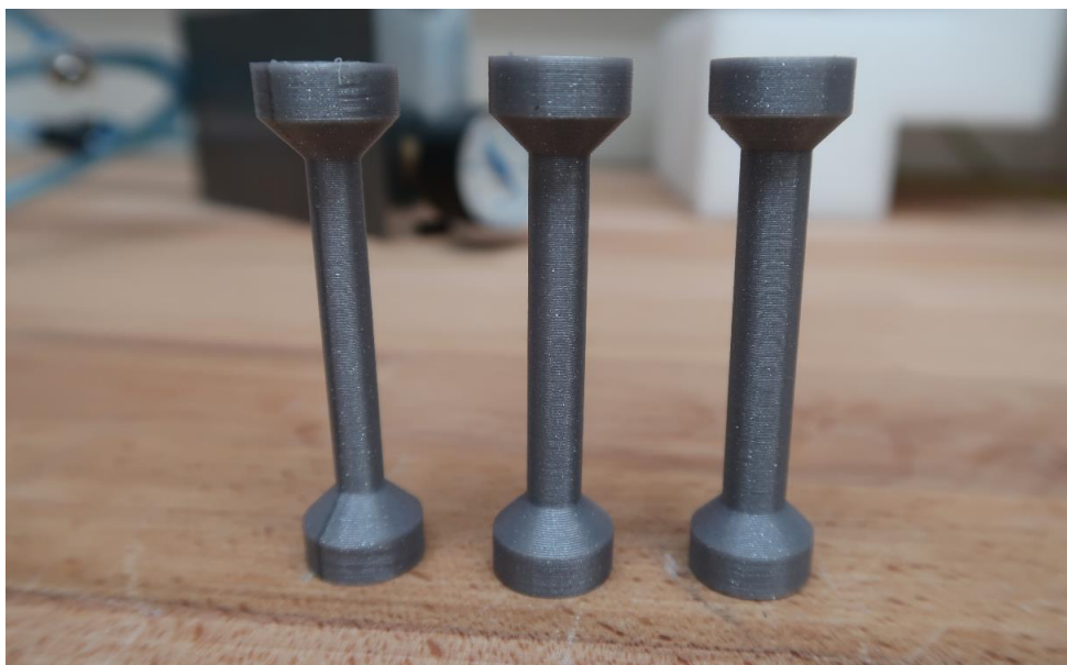
Obrázek 30 Zleva zkušební demonstrátor se dvěma, třemi a čtyřmi perimetry
