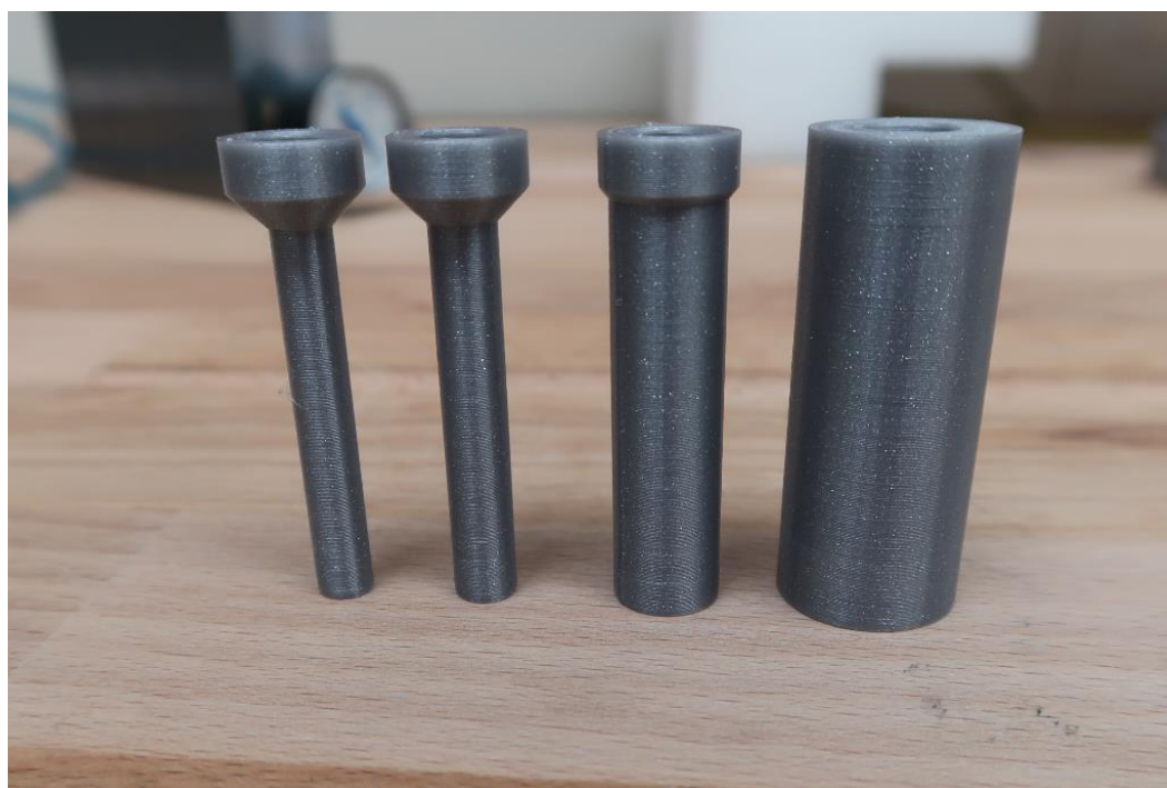
Obrázek 27 Vytištěné zkušební válce o různém počtu perimetrů
