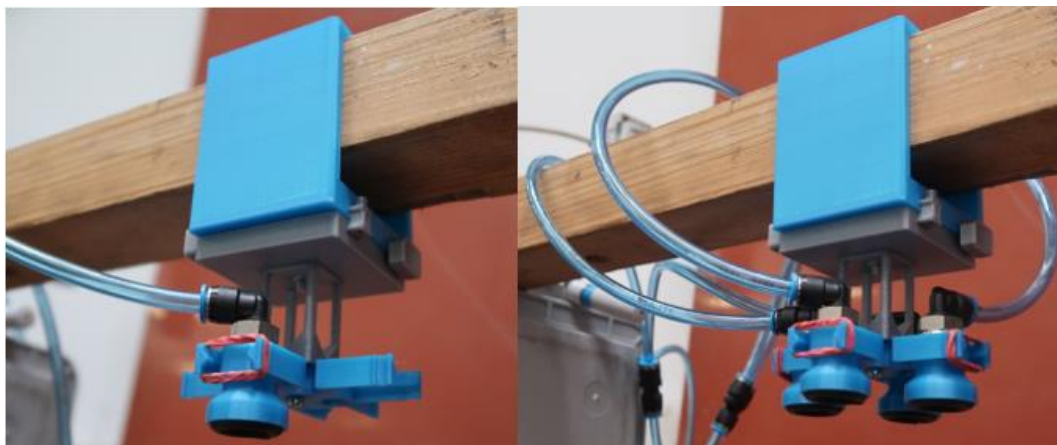
Obrázek 52 Zátěžová zkouška jednoho cupu s těsněním (vlevo), čtyři cupy s těsněním (vpravo)
