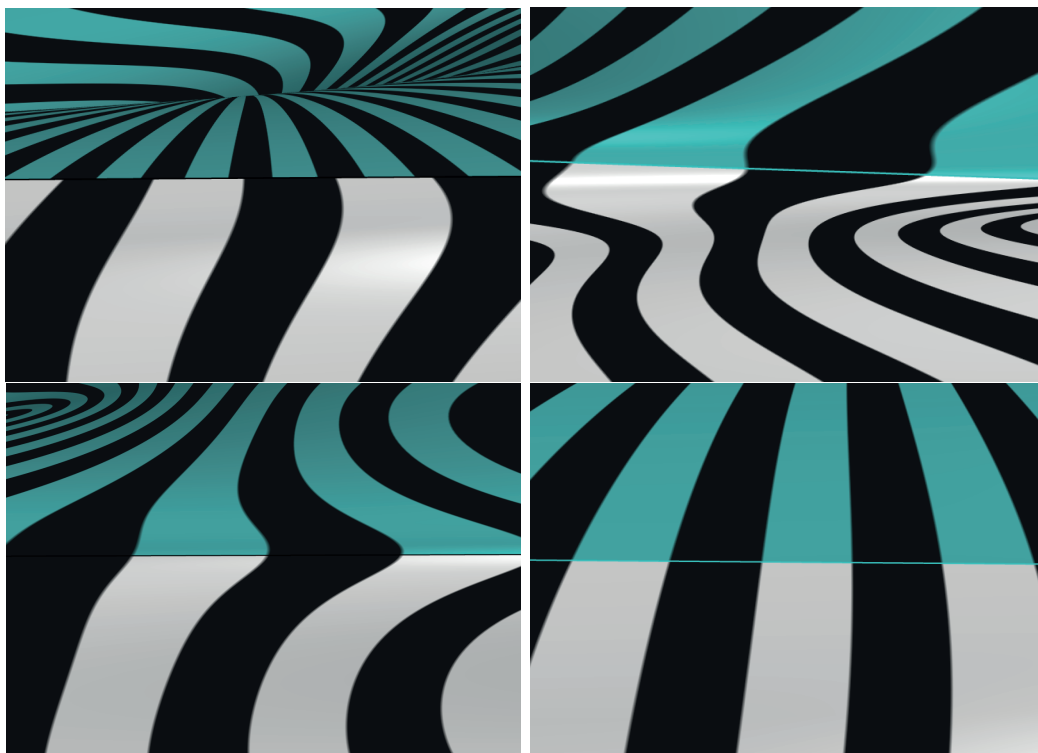
Obrázek 2.5: Detaily analýzy napojení dvou plátů pomocí zebry. Zleva nahoře napojení s G^0 , G^1 , G^2 a G^3 spojitostí.
