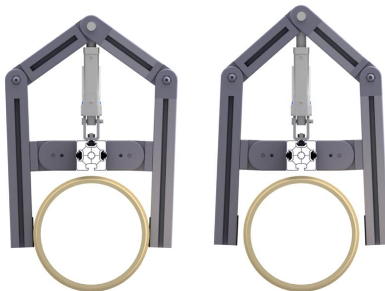
Obrázek 43: Pohyblivý návrh s lineárním aktuátorem v zavřeném a otevřeném stavu
