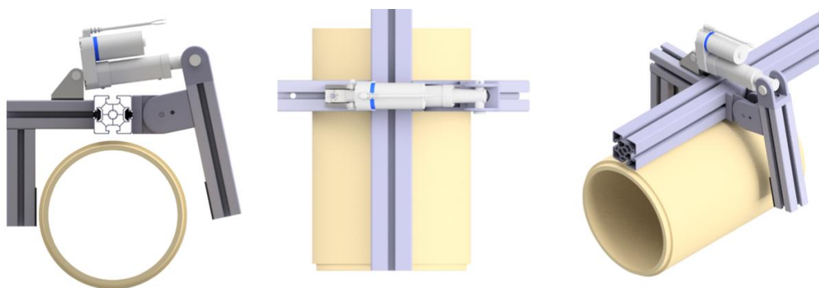
Obrázek 40: 1.Návrh – pevný návrh s lineárním aktuátorem v otevřeném stavu
