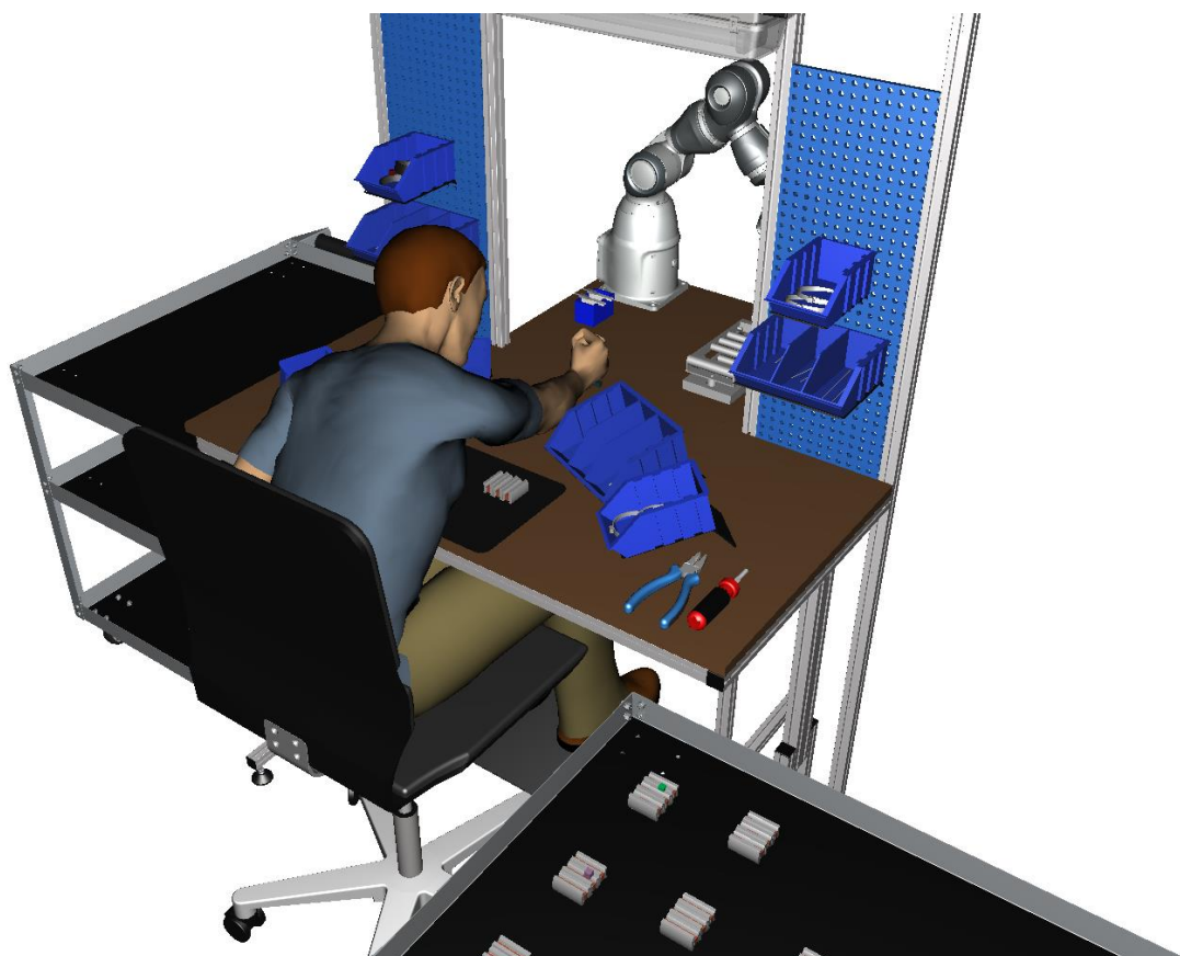
Obr. 34: První varianta: Podávání segmentu robotu
