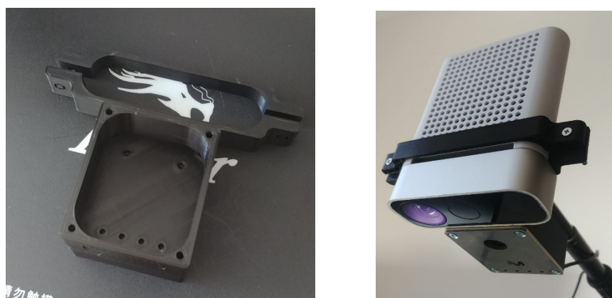
Obrázek 39 - adaptér pro uchycení termokamery vyrobený technologií 3D tisku z materiálu PLA
