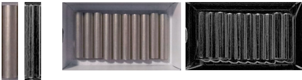
Obrázek 55 – vzor (vlevo) a scéna přiblížená do polohy gitterboxu (vpravo) z kamery RGB se zobrazením výsledků detekce hran
