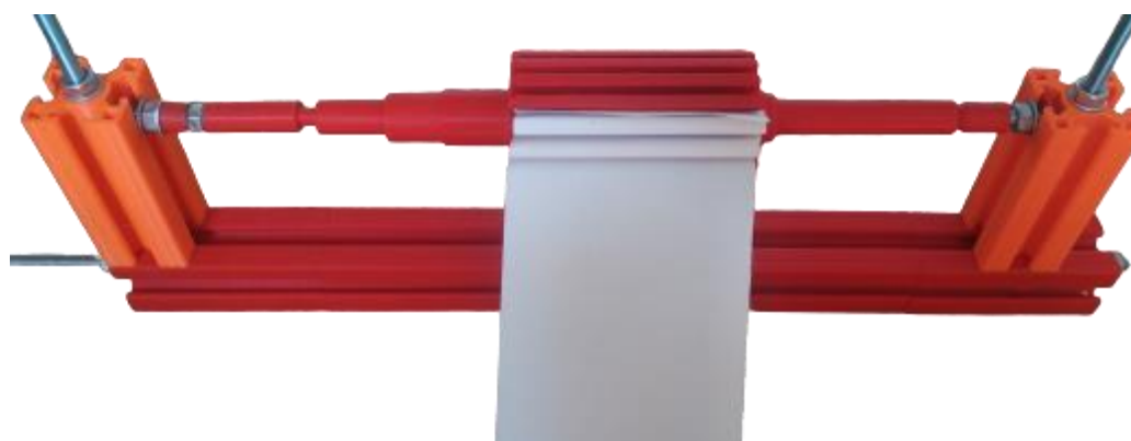
Obrázek 45: Původní upínací přípravek vytištěný pomocí 3D tisku
