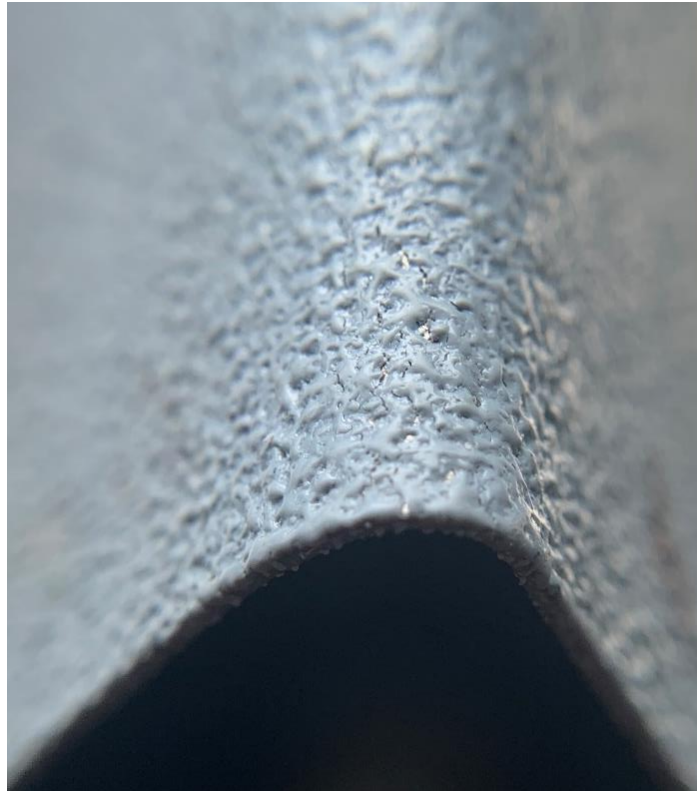
Obrázek 36: Snímek zkoušky ohybem na vzorku č. 9, který při zkoušce vyhověl [foto autora práce]
