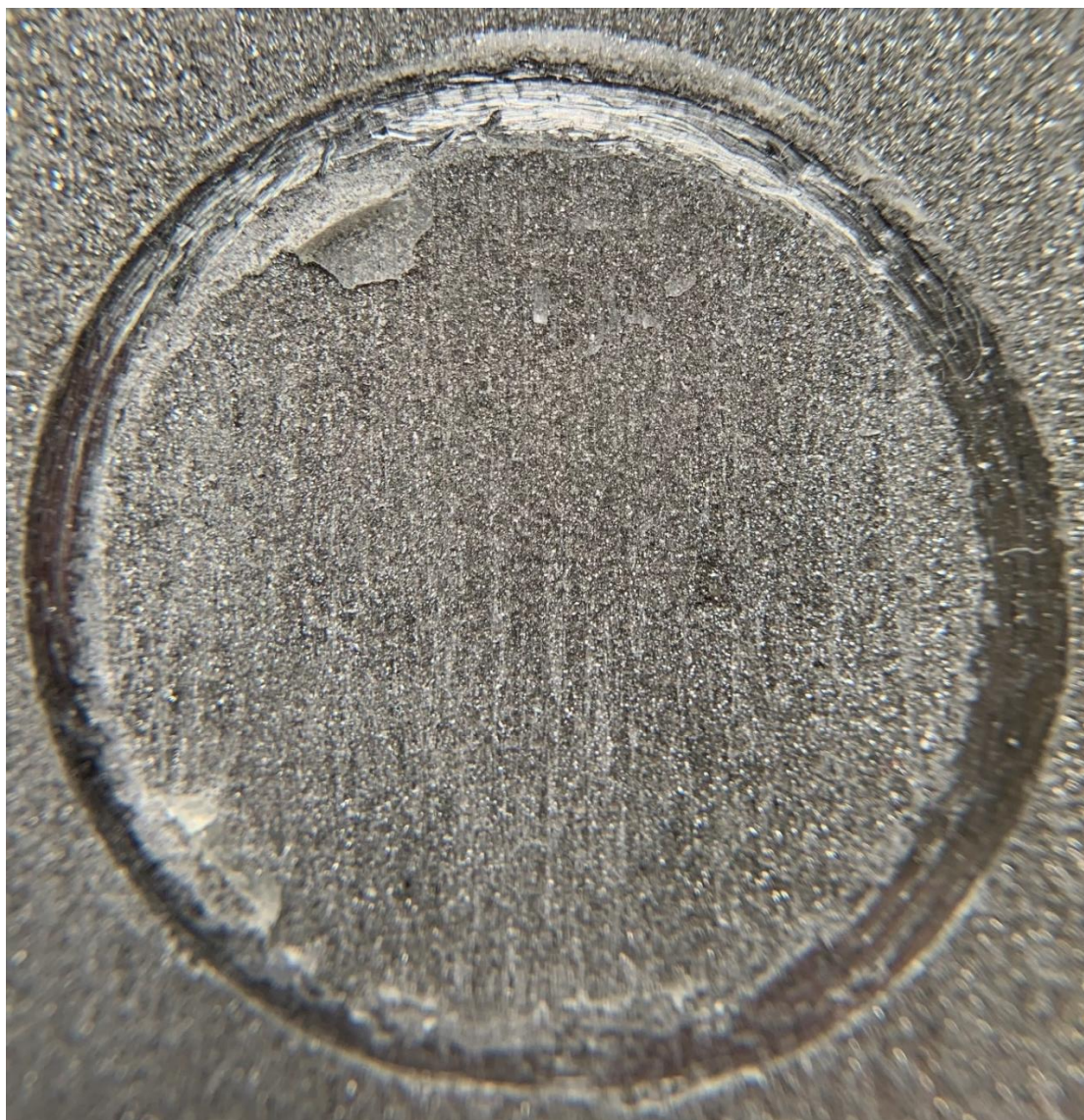
Obrázek 26: Vzorek číslo 2, měření 3 = 10,23 MPa, charakteristika porušení A/Y 95% a Y/Z 5% [foto autora práce]
