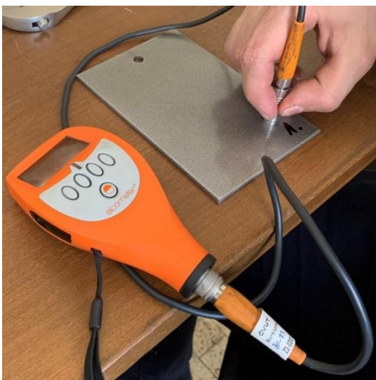
Obrázek 23: Měření tloušťky povlaku [foto autora práce]
