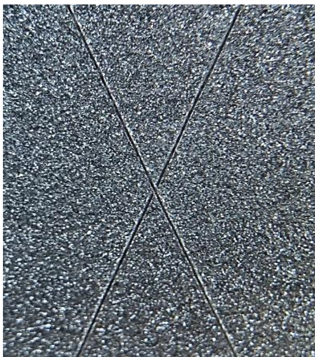
Obrázek 31: Zhotovená zkouška křížovým řezem. Vzorek č. 1, povlakovaný termosetem CPC-20. Hodocení dle normy 5A. [foto autora práce]
