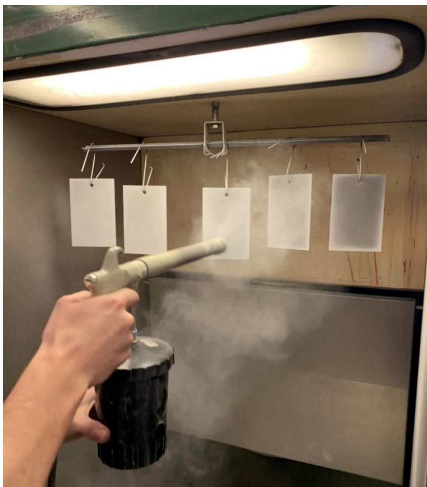
Obrázek 20: Elektrokinetické nanášení práškové barvy v kabině od formy DATEL Ledec s.r.o. [foto autora práce]
