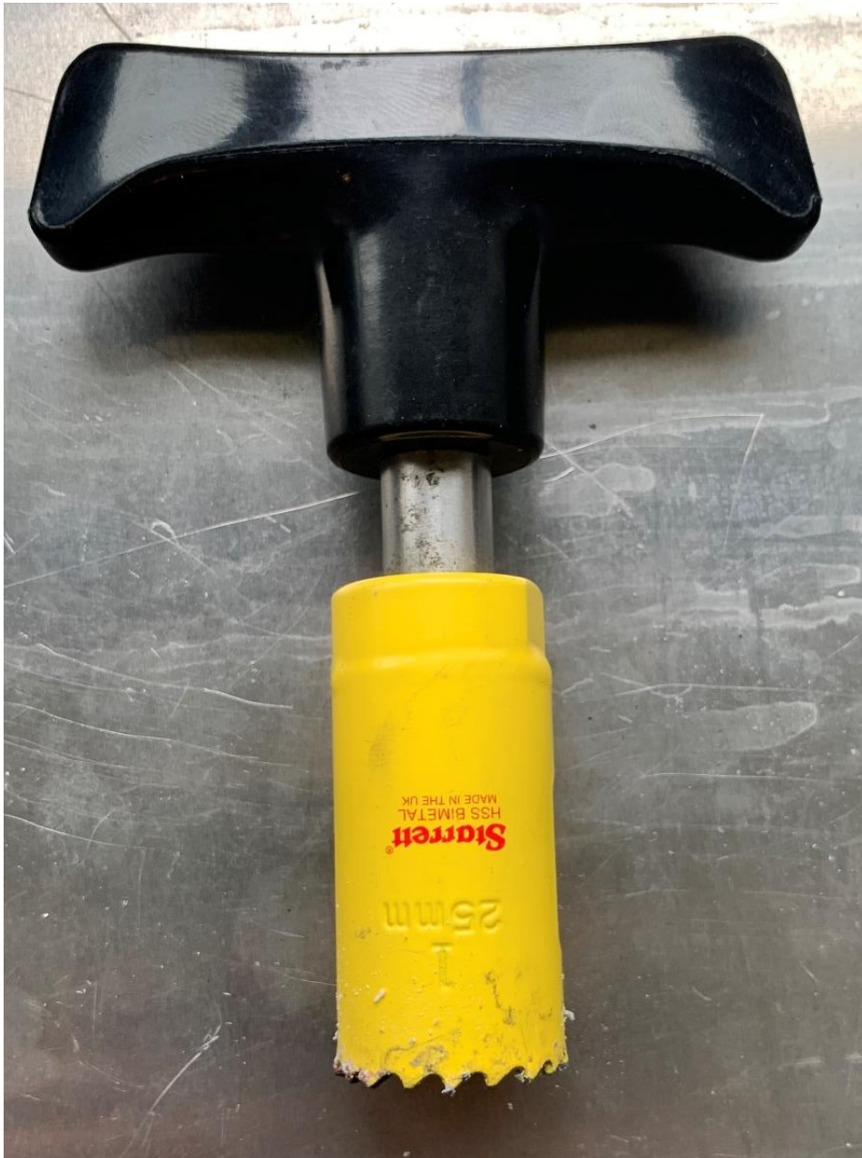
Příloha 10: Ruční řezný nástroj pro zhotovení odtrhové zkoušky [foto autora práce]
