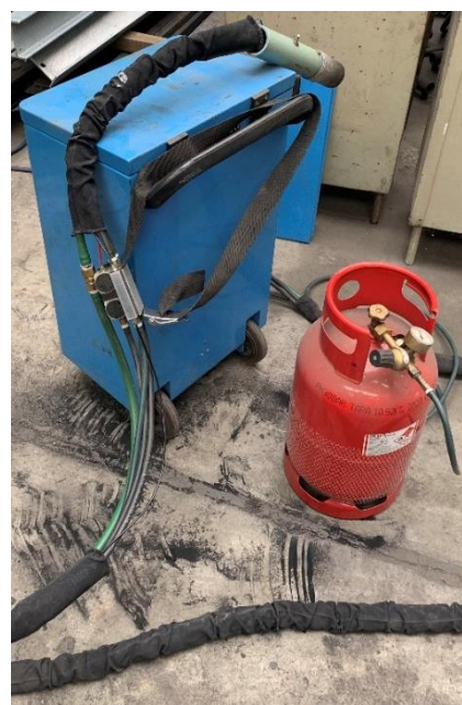
Obrázek 10: Zařízení pro žárový nástřik práškových plastů [foto autora práce]
