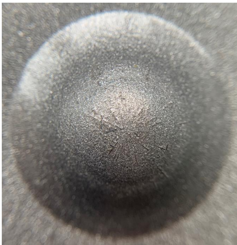
Obrázek 38: Vzorek č.2 po zkoušce hloubením s elektrokineticky nanášeným plastem CPC-20 hodnocený dle normy KE 30 KT 01 [foto autora práce]
