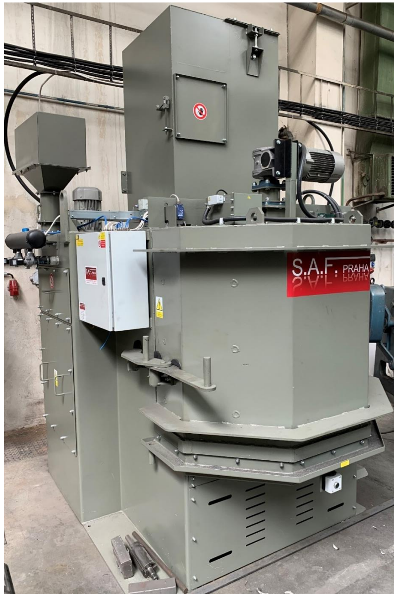
Obrázek 19: Kombinované stolové a závěsné tryskací zařízení od firmy S.A.F. Praha [foto autora práce]
