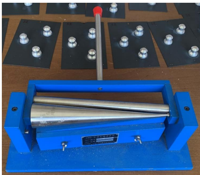
Obrázek 33: Kónický trn pro ohyb zkušebního vzorku podle normy ČSN EN ISO 6860 [foto autora práce]
