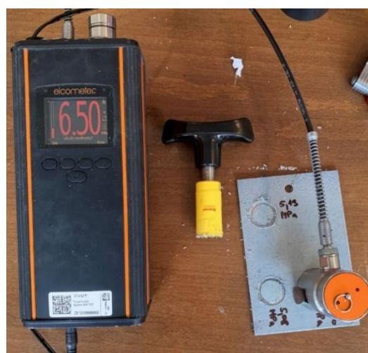
Obrázek 24: Sada na provedení odtrhové zkoušky [foto autora práce]
