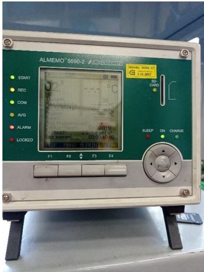
Obrázek 9.-Měřící stanice ALMEMO.
