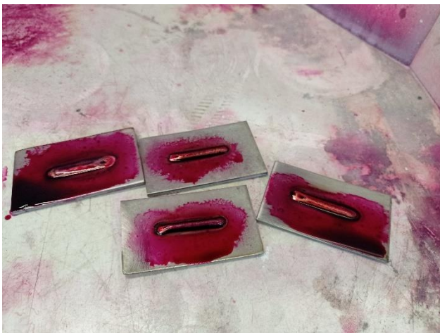
Obrázek 21.-Foto z průběhu kapilární zkoušky.
