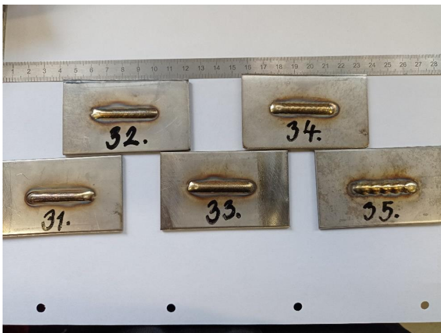
Obrázek 25.-Navařené vzorky pro jednotlivé doby pulsu/prodlevy.
