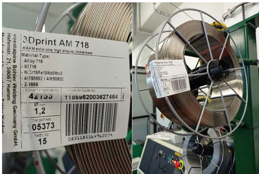
Obrázek 16.-Přídavný drát z Inconelu 718.
