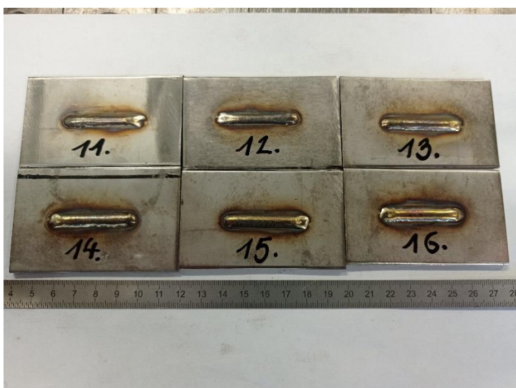
Obrázek 24.-Jednotlivé vzorky návarů se změnou parametru frekvence.
