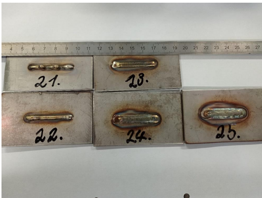
Obrázek 19.- Jednotlivé návary při změně velikosti proudů.
