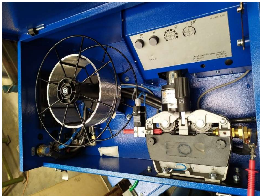
Obrázek 9 - Náhled čtyř kladkového podavače (pohled shora)
