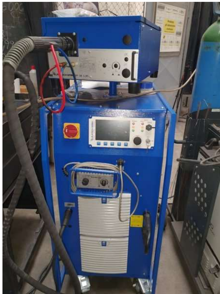
Obrázek 7 - Svařovací zdroj Elmatech GmbH VARIO MIG 4003 AC/DC DV 36
