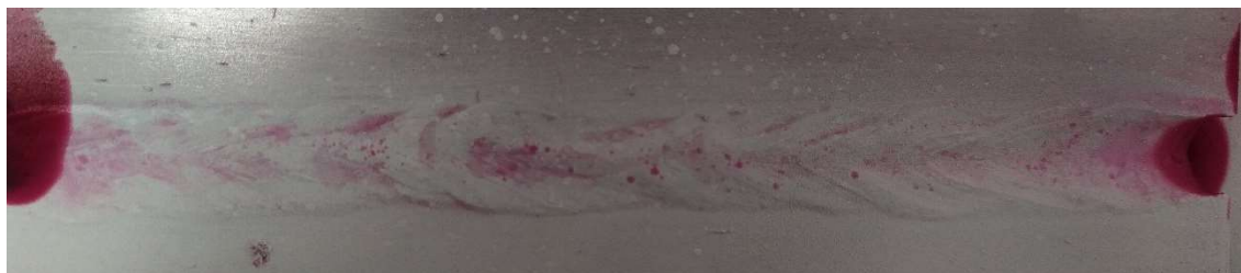
Obrázek 32 - Výsledek kapilární zkoušky vzorku KU_4
