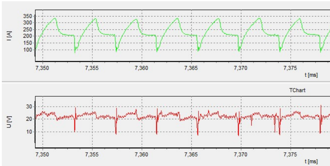
Obrázek 26 - Průběh proudu a napětí v závislosti na čase u vzorku KU_AC_2
