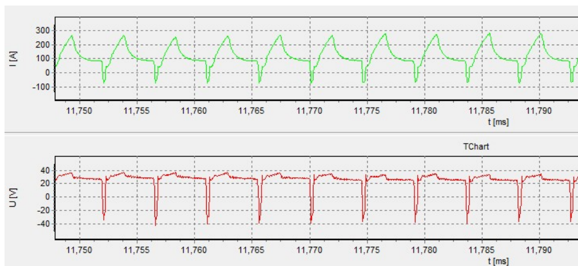
Obrázek 24 - Průběh proudu a napětí v závislosti na čase u vzorku KU_AC_1
