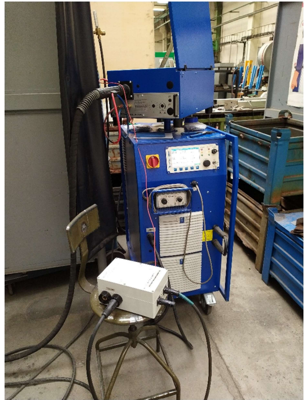
Obrázek 11 - Zapojení monitorovacího systému Weldmonitor 4.5
