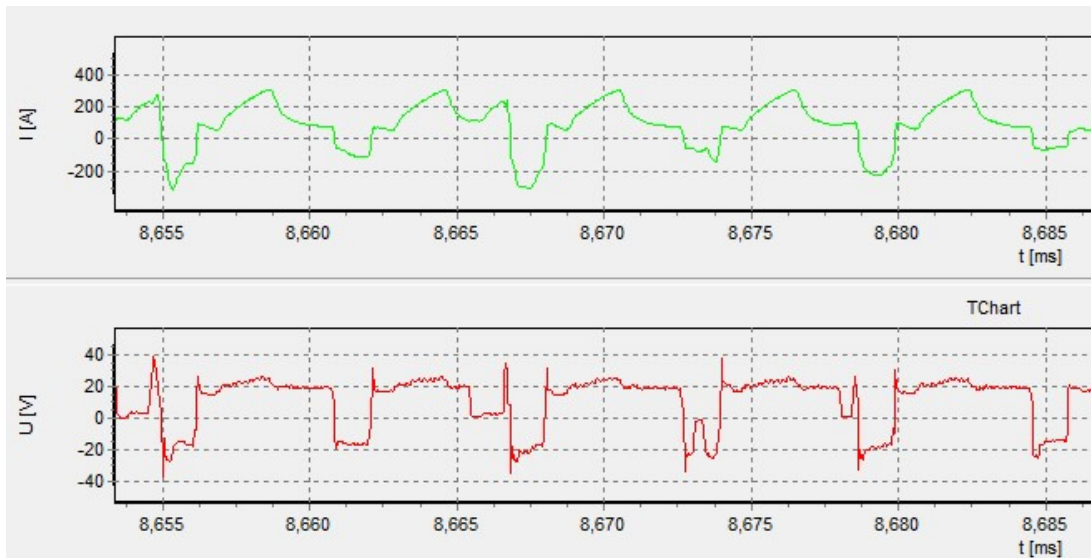
Obrázek 30 - Průběh proudu a napětí v závislosti na čase u vzorku KU_AC_4
