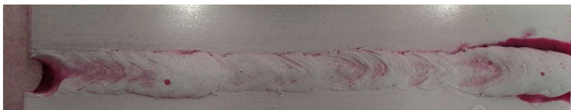
Obrázek 33 - Výsledek kapilární zkoušky vzorku KU_AC_4
