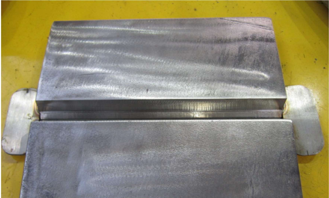
Obrázek 19 - Ukázka použití náběhových a výběhových desek
