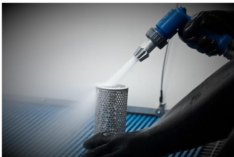
Obrázek 5: Tryskání zvlhčeným abrazivem [21]
