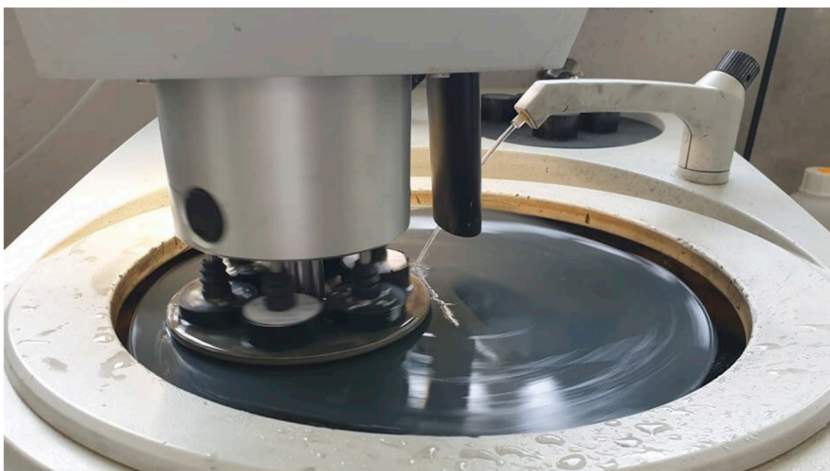
Obrázek 11.5: Broušení vzorků na metalografické brusce Struers LaboForce-100.
