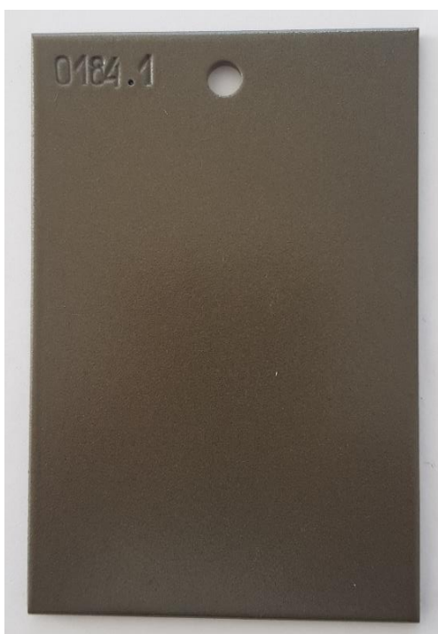
Obrázek č. 18 Ocel otryskaná na stupeň čistoty Sa3
