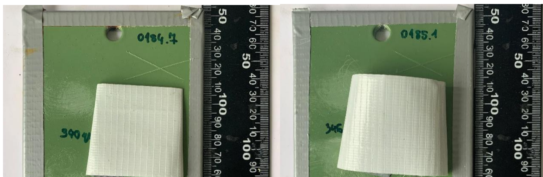
Obrázek č. 31 0184.7 Křížový řez po expozici NSS Obrázek č. 32 0185.1 Křížový řez po expozici NSS
