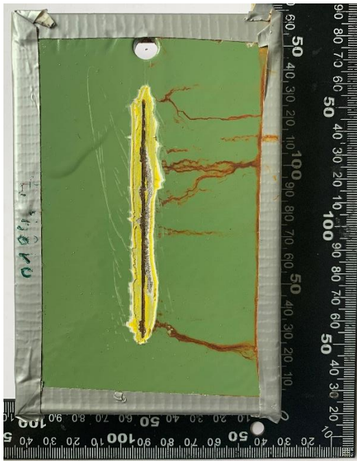
Obrázek č. 74 0184.7 Klasifikace koroze
