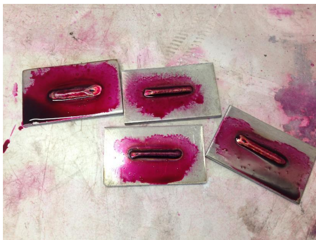
Obrázek 36: Kapilární zkouška-Nanesení penetrantu
