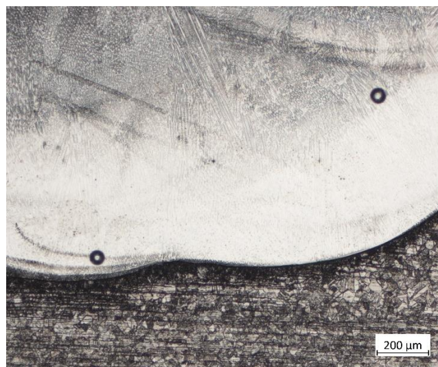
Obrázek 46: Póry v prvním návaru Ar + 5 % H 2 (zvětšení 200x)
