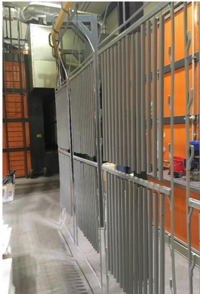
Obrázek 5 Trubky z pece po vytvrzení
