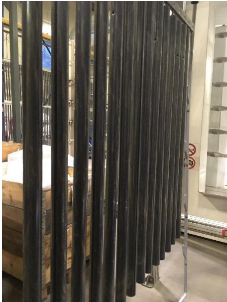
Obrázek 9: Surové odmaštěné trubky
