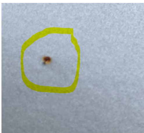
Obrázek 42: Detail vzorku č.35, prorezavění, NSS
