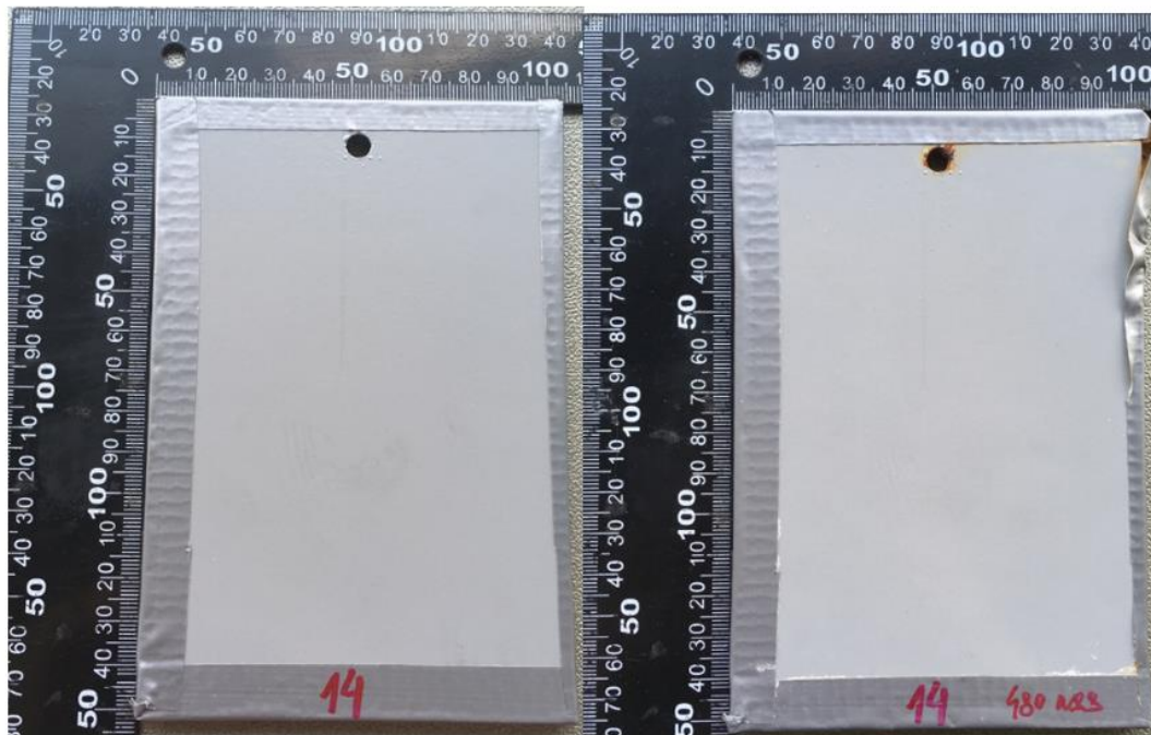
Obrázek 33: Vzorek č.14, vlevo před korozní zkouškou vpravo po době expozice 480 h, s předúpravou
