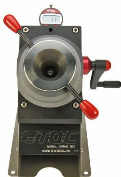
Obrázek 15: Přístroj na testování odolnosti práškové barvy [34]
