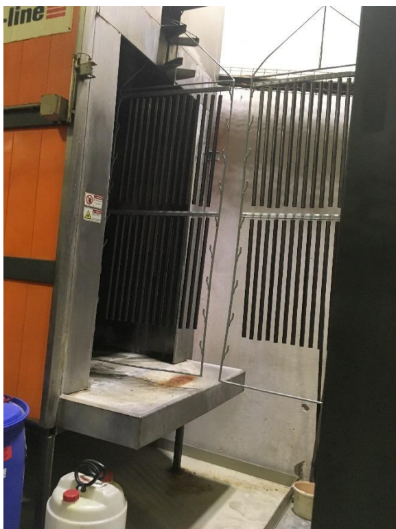
Obrázek 8: Vstup trubek v rámech do předúpravy
