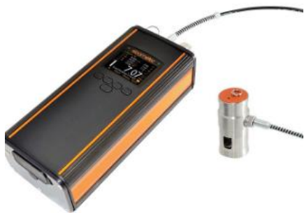
Obrázek 14: Automatický odtrhoměr Elcometer 510 [41]
