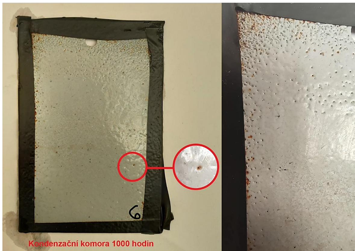
Obrázek č. 42 Vzorek číslo 6 ošetřen žárovým povlakem po 1 000 hodinách v kondenzační komoře
