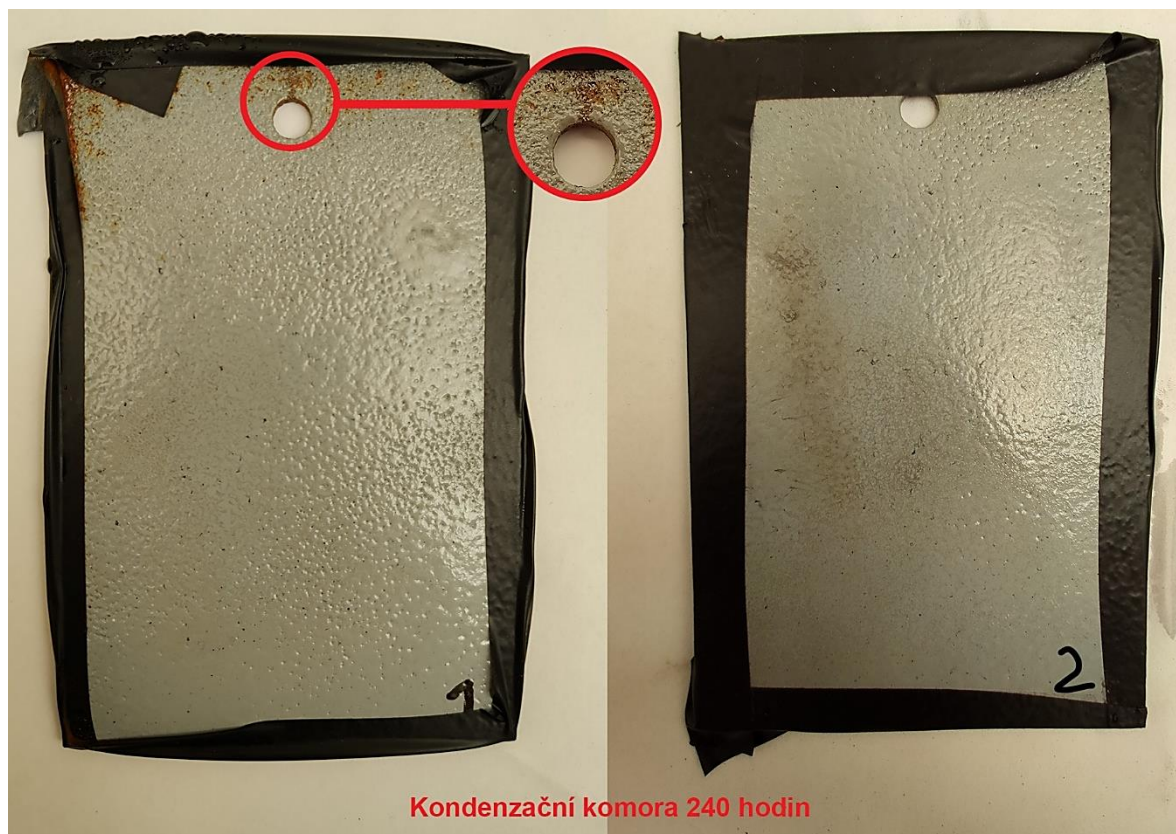
Obrázek č. 36 Vzorky 1 a 2 ošetřeny žárovým povlakem po 240 hodinách v kondenzační komoře
