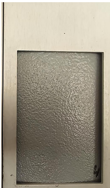
Obrázek č. 46 Vzorek s žárovým povlakem v přípravku pro QUV komoru po 1 000 hodinách v komoře
