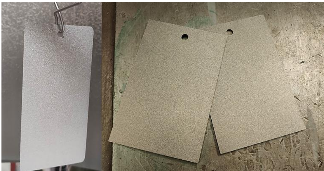
Obrázek č. 21 Otryskané vzorky (vlevo otryskaný Q panel, vpravo otryskané vzorky plechu)
