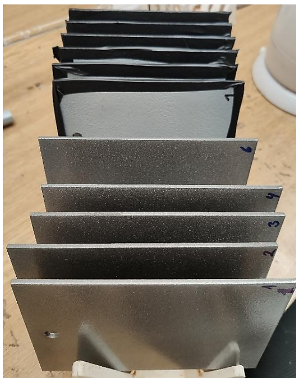
Obrázek č. 33 Vzorky v držáku pro kondenzační komoru
