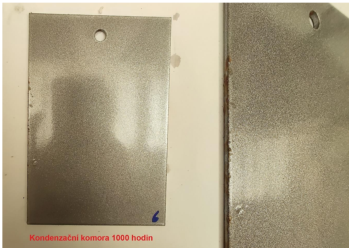
Obrázek č. 41 Vzorek číslo 6 ošetřen elektrokineticky naneseným povlakem
