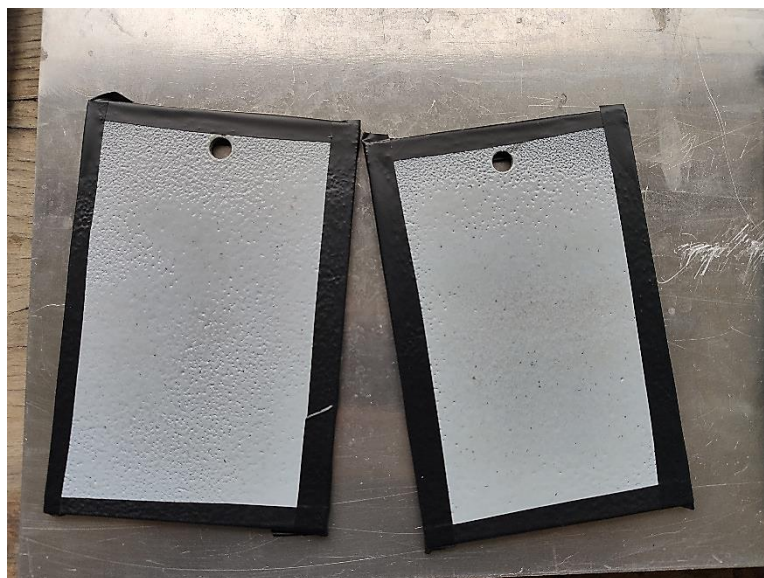
Obrázek č. 32 Vzorky s žárovým povlakem oblepeny páskou, aby nekorodovaly od hran
