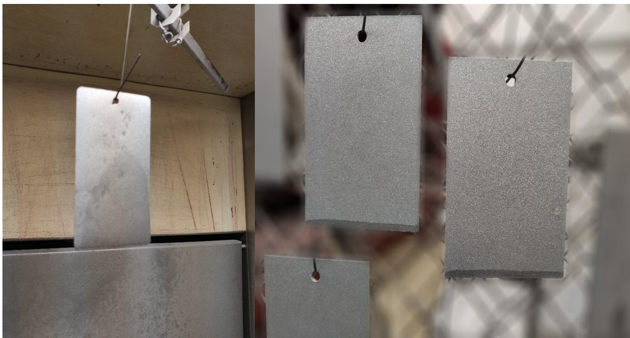
Obrázek č. 22 Schnoucí vzorek na elektrokinetický nástřik (vlevo), Schnoucí vzorek na žárový povlak (vpravo)
