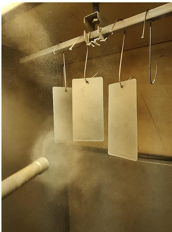
Obrázek č. 24 Nástřik elektrokinetickou metodou
