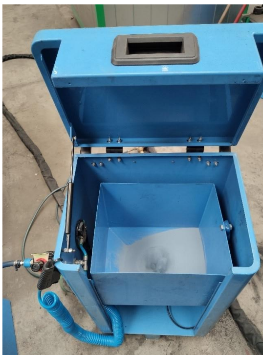
Obrázek č. 27 Připravený stroj pro žárový nástřik s nasypanou termoplastickou práškovou hmotou
