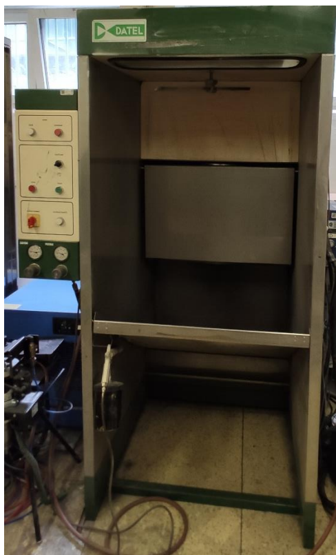
Obrázek č. 23 Pracoviště na elektrokinetický nástřik práškového povlaku
