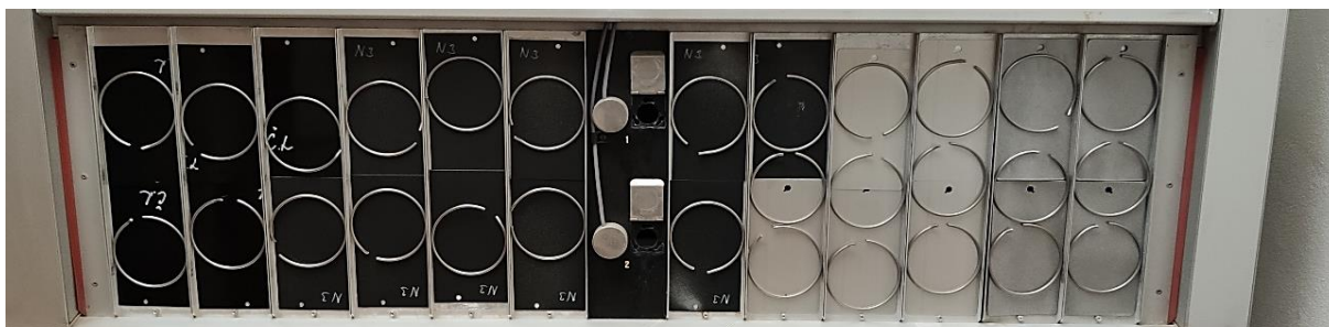
Obrázek č. 34 Vkládání vzorků do QUV komory
