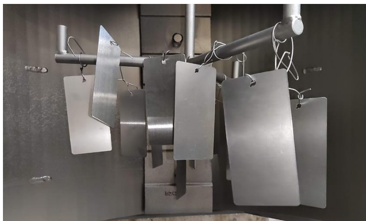
Obrázek č. 20 Zavěšené vzorky na samootočném přípravku, před tryskáním
