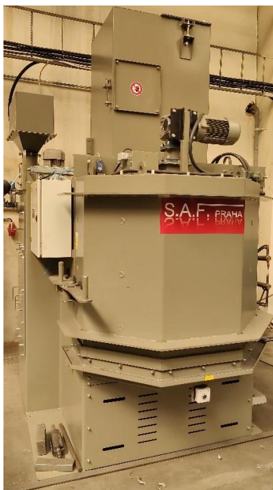
Obrázek č. 19 Automatický tryskací stroj od společnosti S.A.F Praha
