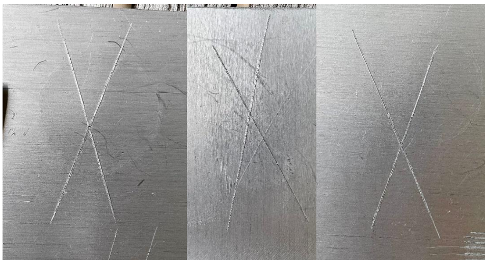
Obr. 19: Zkouška křížovým řezem na vzorcích 2-1, 2-2, 2-3 – Anodická oxidace stříbrná
