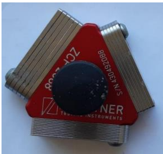
Obr. 14: Šablona pro zkoušku mřížkovým řezem – Zehntner ZFC 2088 [78]
