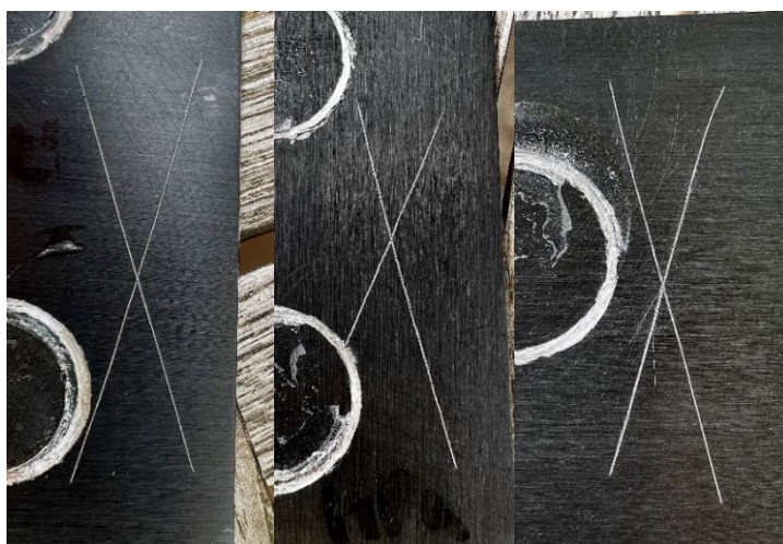
Obr. 18: Zkouška křížovým řezem na vzorcích 1-1, 1-2, 1-3 – Anodická oxidace černá
