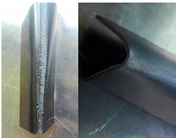
Obr. 22: Vzorky 1-5 a 1-6 po zkoušce ohybem na kónickém trnu – Anodická oxidace černá
