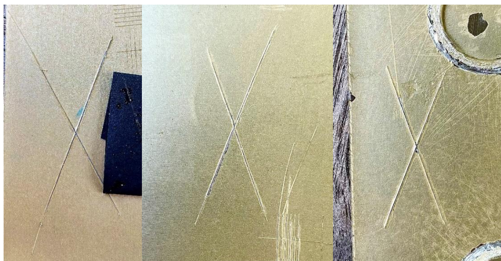
Obr. 20: Zkouška křížovým řezem na vzorcích 3-1, 3-2, 3-3 – Práškový plast
