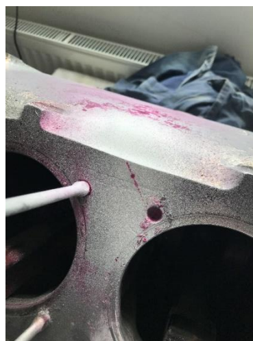
Obrázek 72: Kapilární zkouška – nanesení detekční látky [48]
