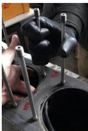
Obrázek 41: Svírání svorníků za účelem odhalení defektů [48]
