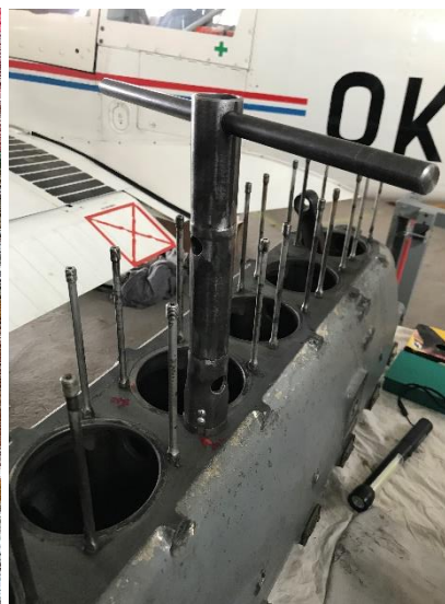
Obrázek 57: Demontáž svorníku z klikové skříně [48]
