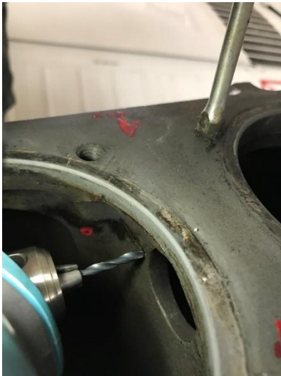
Obrázek 60: Proces odvrtávání praskliny klikové skříně [48]
