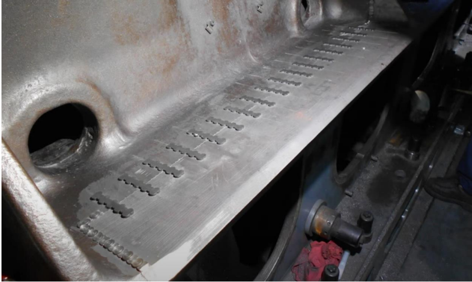
Obrázek 29: Aplikace metody Lock and stitch [39]
