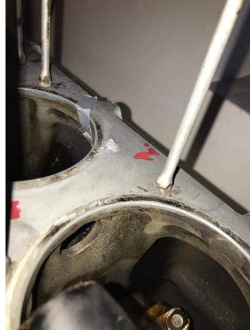
Obrázek 69: Vyplněná dutina materiálem Metal-plastic [48]
