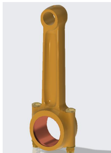
Obrázek 12: Ojnice motoru M-137, snímek z 3D modelu [48]
