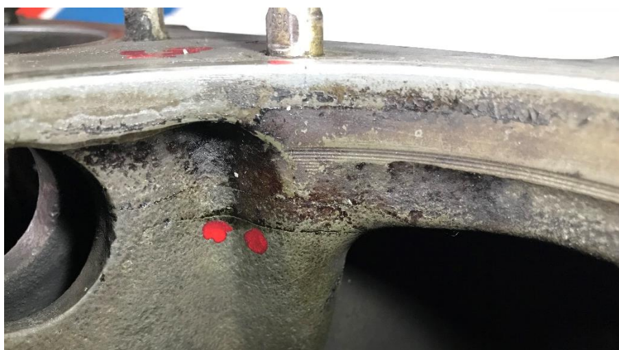
Obrázek 47: Detailní pohled dvojité praskliny válce č. 3, svorníku č. 4 [48]
