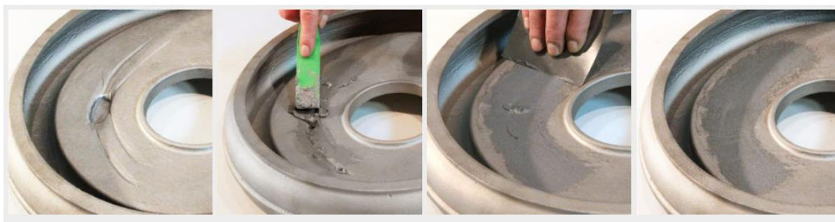
Obrázek 31: Postup opravy zmetkového odlitku [21]
