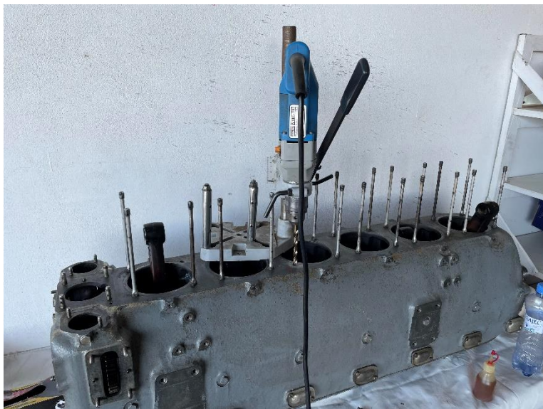
Obrázek 78: Sestava vrtačky a stojanu pro vrtání svorníkových otvorů [48]
