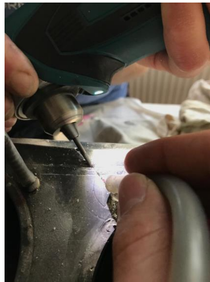
Obrázek 74: Frézování „V“ drážky praskliny [48]
