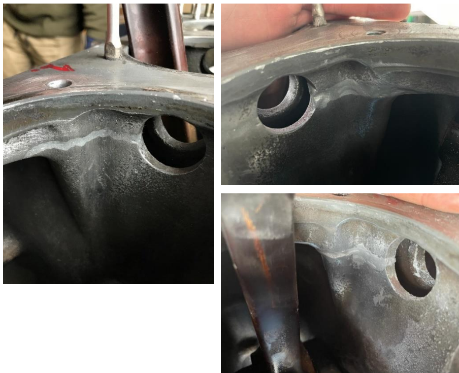
Obrázek 70: Fotografie vyplněných drážek materiálem Metal-plastic [48]
