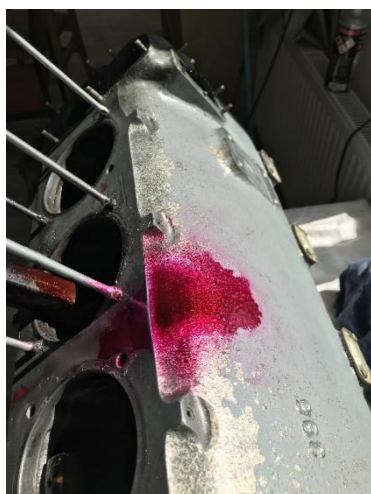
Obrázek 71: Kapilární zkouška – nanesení indikační látky [48]
