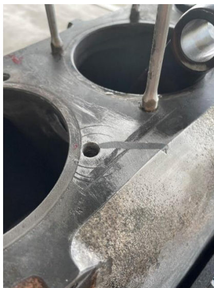
Obrázek 75: Vyplněná drážka praskliny Metal-plastic materiálem [48]
