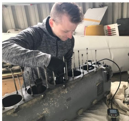
Obrázek 44: Průběh inspekce pomocí boroskopu [48]
