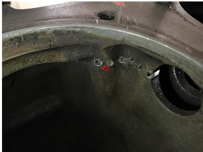
Obrázek 61: Proces odvrtávání praskliny klikové skříně [48]
