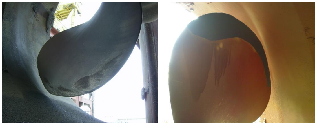
Obrázek 32: Oprava poškozeného lodního šroubu vlivem kavitace
