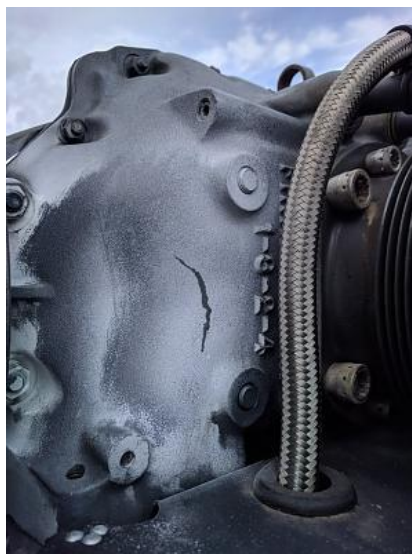
Obrázek 24: Kapilární zkouška provedená na klikové skříni motoru Lycoming [38]
