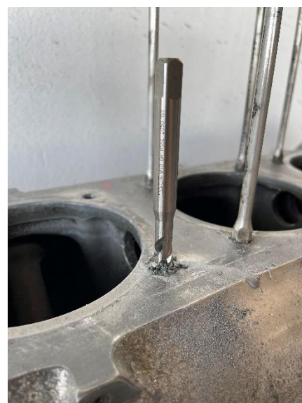
Obrázek 79: Řezání závitů pomocí závitníku M10x1.25 [48]
