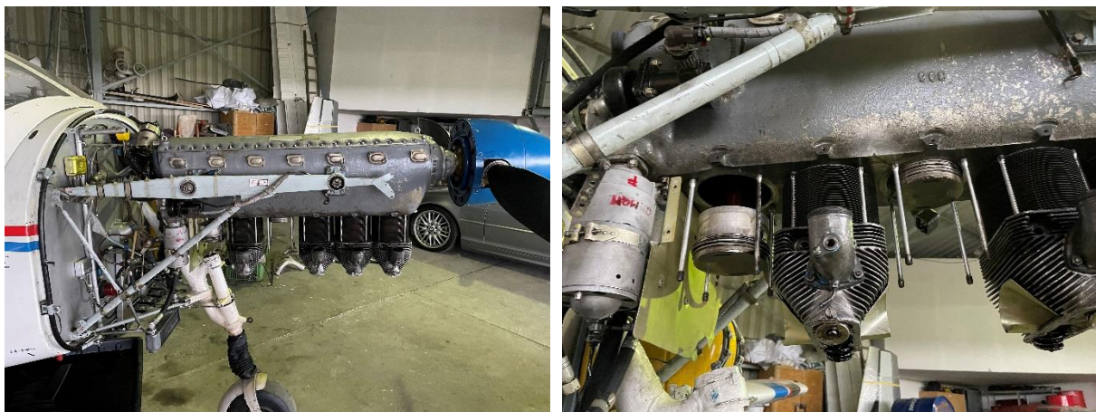
Obrázky 82: postup demontáže hlav a válců za účelem kontroly stavu oprav [48]
