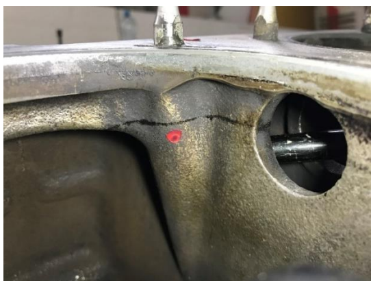
Obrázek 6: Prasklina v odlitku klikové skříně motoru M-137 [48]
