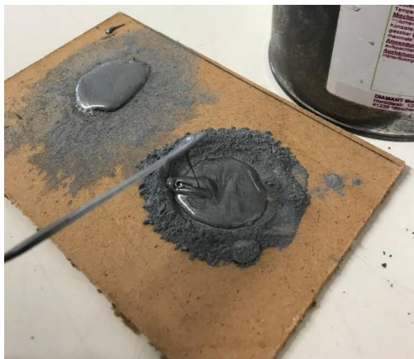
Obrázek 55: Namíchaná směs Metal-plastic materiálu [48]
