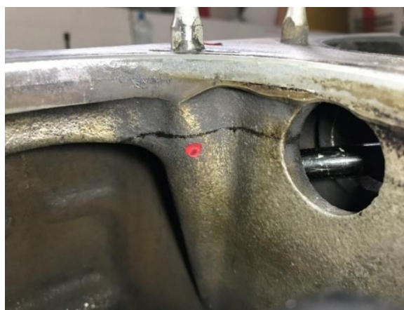
Obrázek 42: Odhalená prasklina klikové skříně [48]
