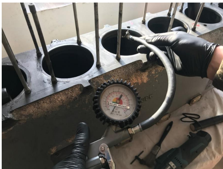
Obrázek 66: Odstraňování špon a volných nečistot stlačeným vzduchem [48]
