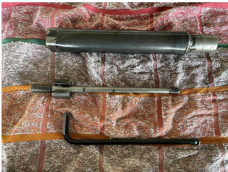
Obrázek 56: Přípravek pro demontáž svorníků [48]
