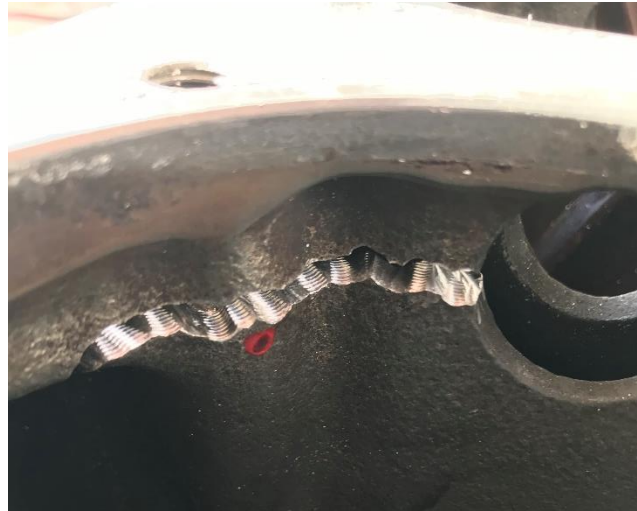
Obrázek 65: Vyfrézovaná drážka se závity [48]
