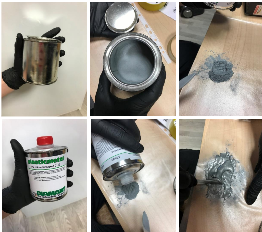
Obrázky 67: Postup přípravy materiálu Metal-plastic [48]
