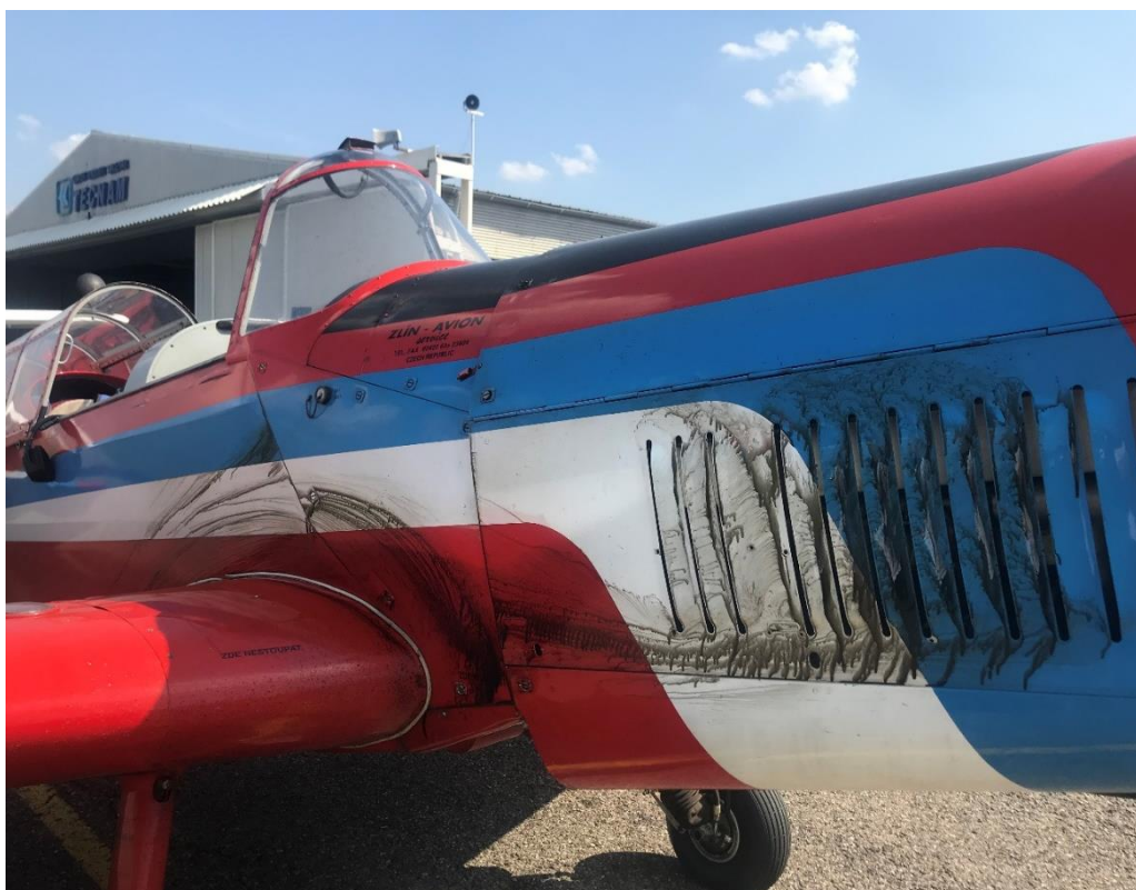
Obrázek 4: Únik oleje z motorového prostoru letounu Z-226MS [48]
