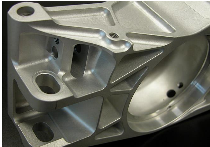
Obrázek 4: Součást z leteckého hliníku vyztužená částicemi karbidu křemíku
