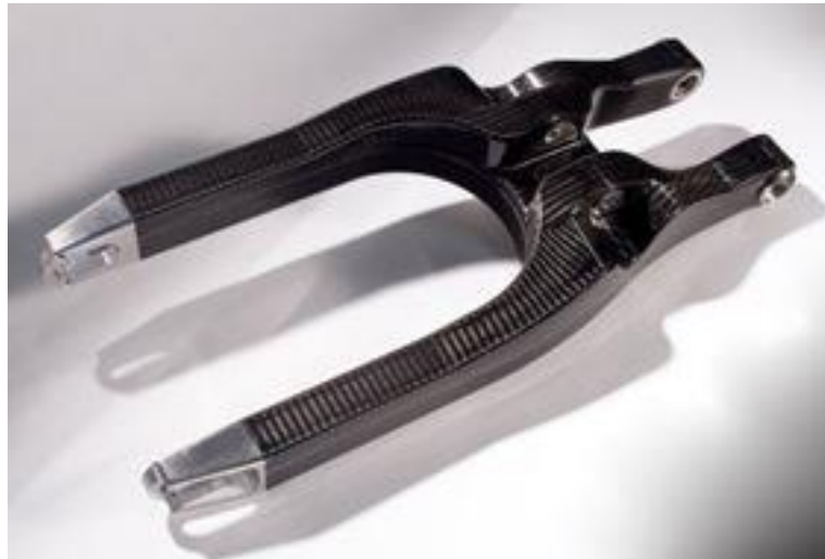
Obrázek 13: Křivná vidlice BMW z uhlíkového kompozitu s titanovými inserty
