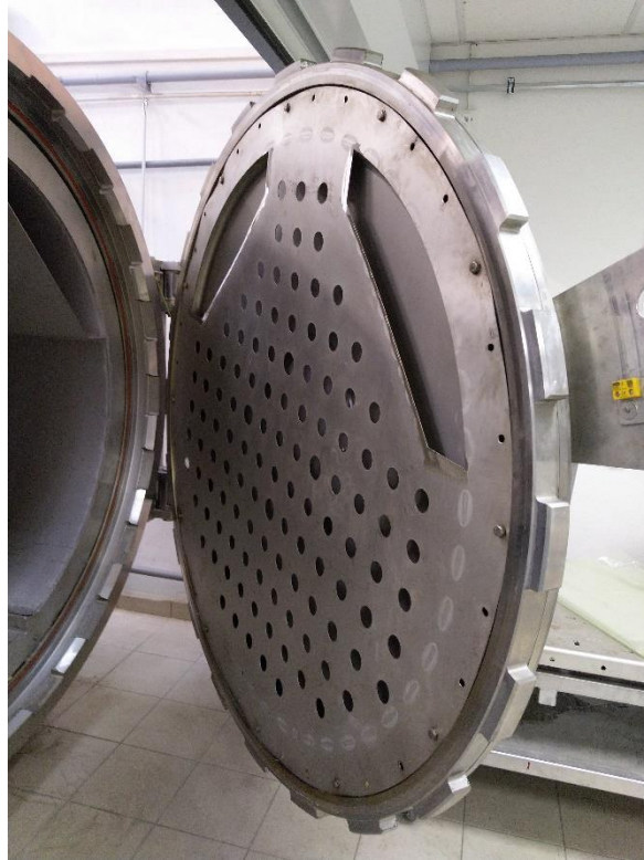
Obrázek 37: Dveře autoklávu s kanálem pro rozvod ohřátého vzduchu
