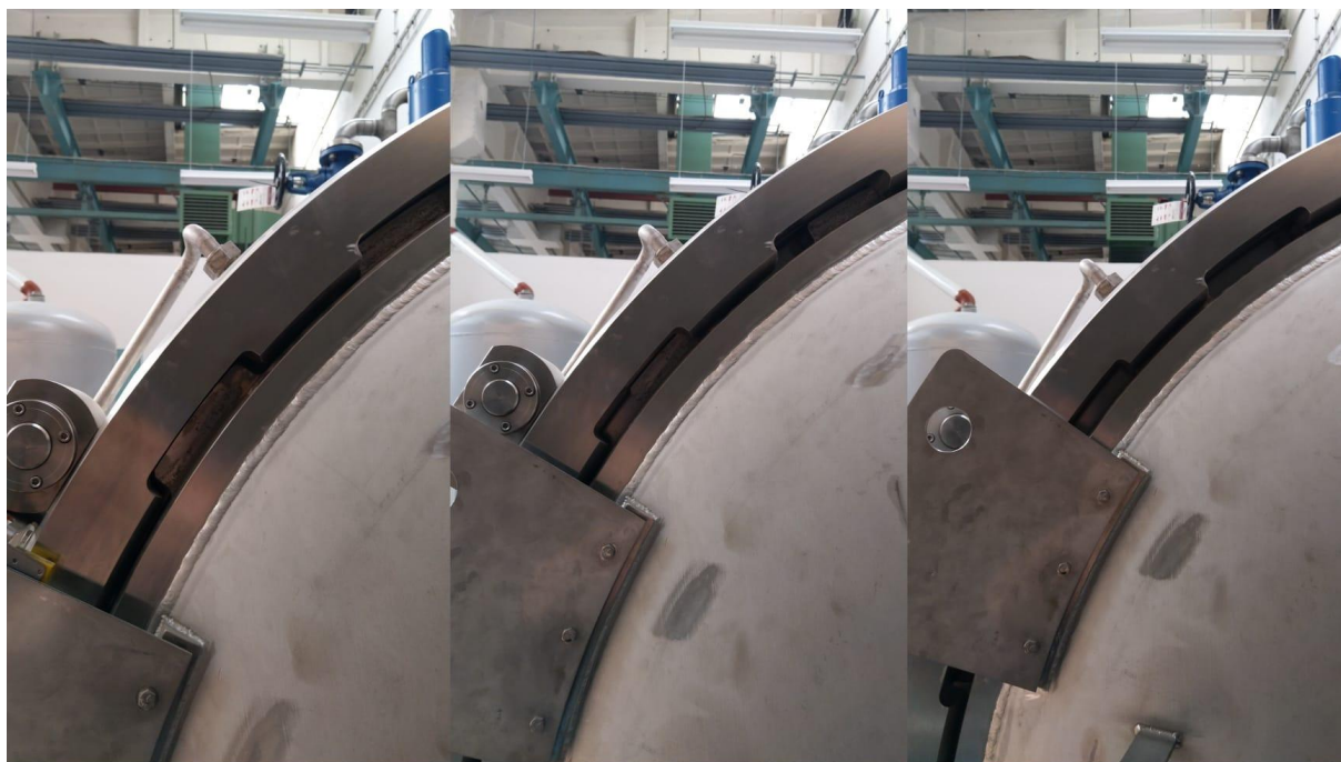
Obrázek 39: Zásuvný zámkový systém (zleva otevřený, napůl zavřený, zavřený)
