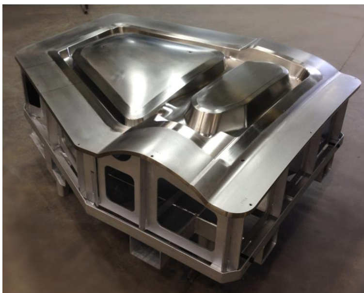
Obrázek 31: Forma pro výrobu kompozitních součástí pro vesmírný průmysl
