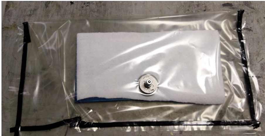
Obrázek 73: Vzorky utěsněné ve vaku, připravené na vakuování
