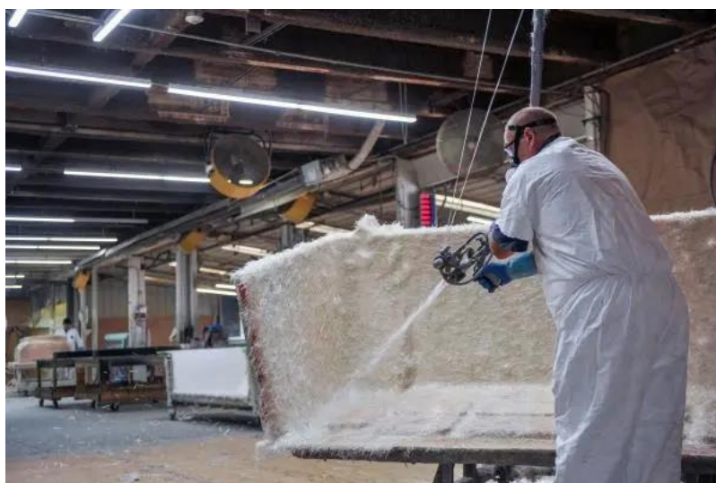
Obrázek 26: Stříkání rovingu s pojivem na formu
