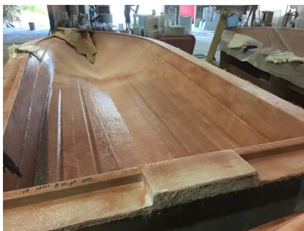
Obrázek 15: Trup lodi ve formě vyrobený ručním kladením
