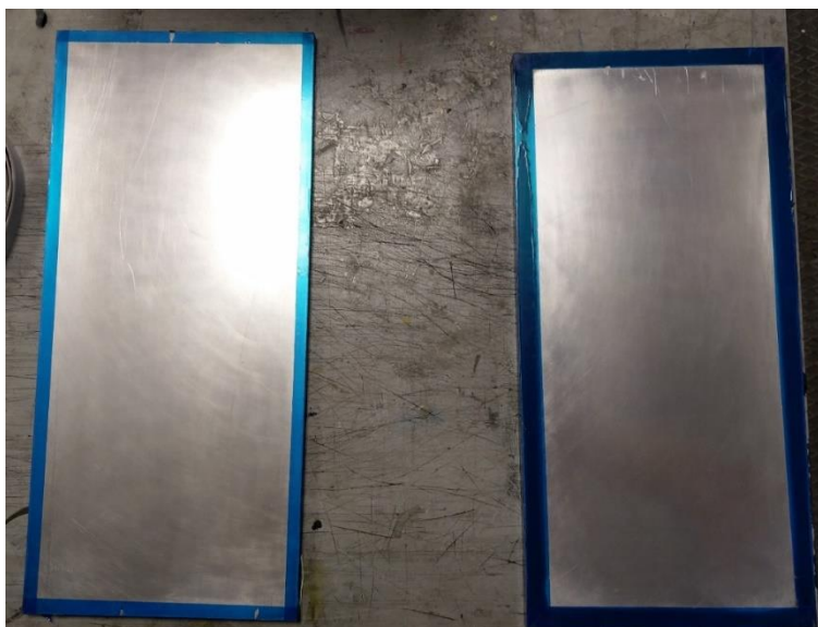
Obrázek 67: Hliníkové desky, které byly použity jako formy
