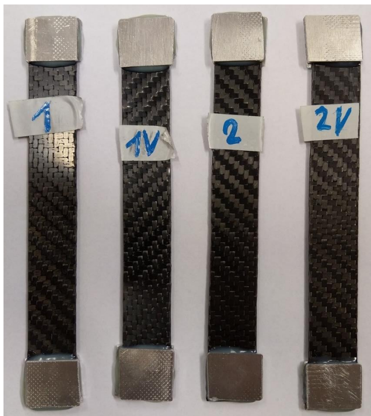
Obrázek 79: Vzorky po 24 hodinách s přilepenými hliníkovými destičkami
