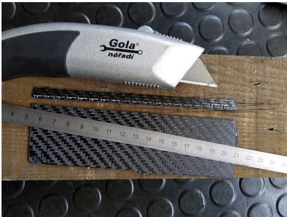
Obrázek 77: Řezání vzorků na tahovou zkoušku
