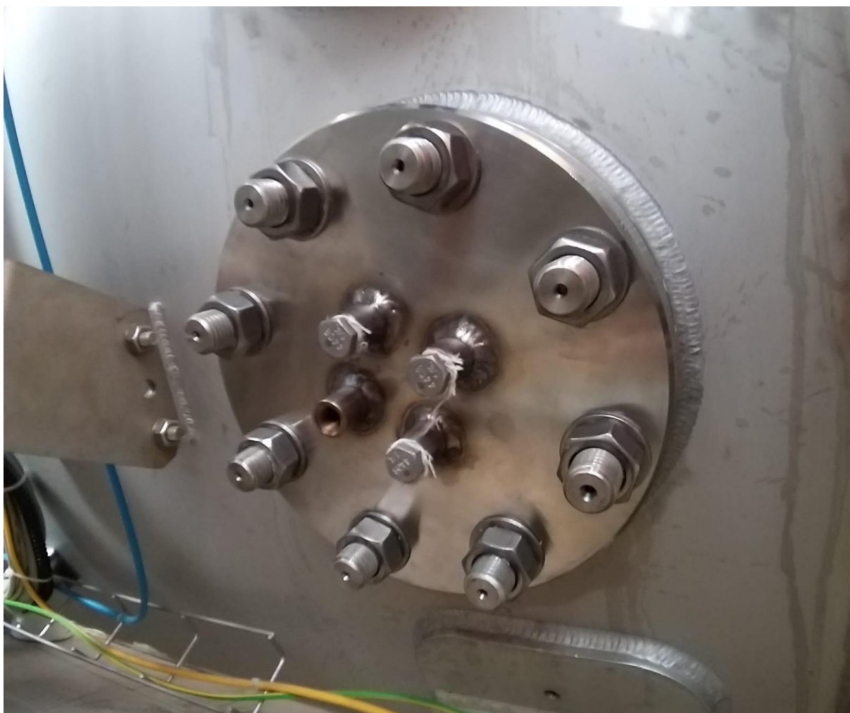
Obrázek 62: Nainstalovaná příruba se zaslepenými vývody (pohled z vnější strany autoklávy)
