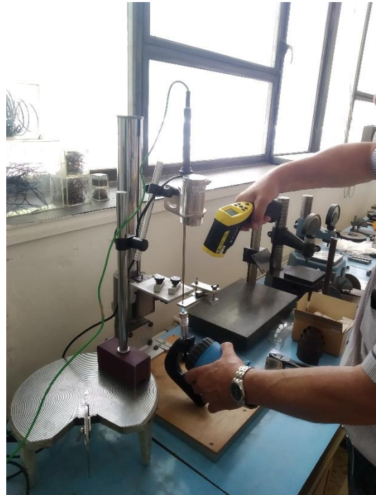
Obrázek 23 Měření teploty pyrometrem AMiR 7811-20
