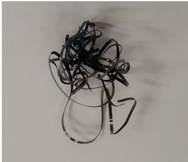
Obrázek 31 Vytvořená tříška při hloubce řezu 0,4 mm
