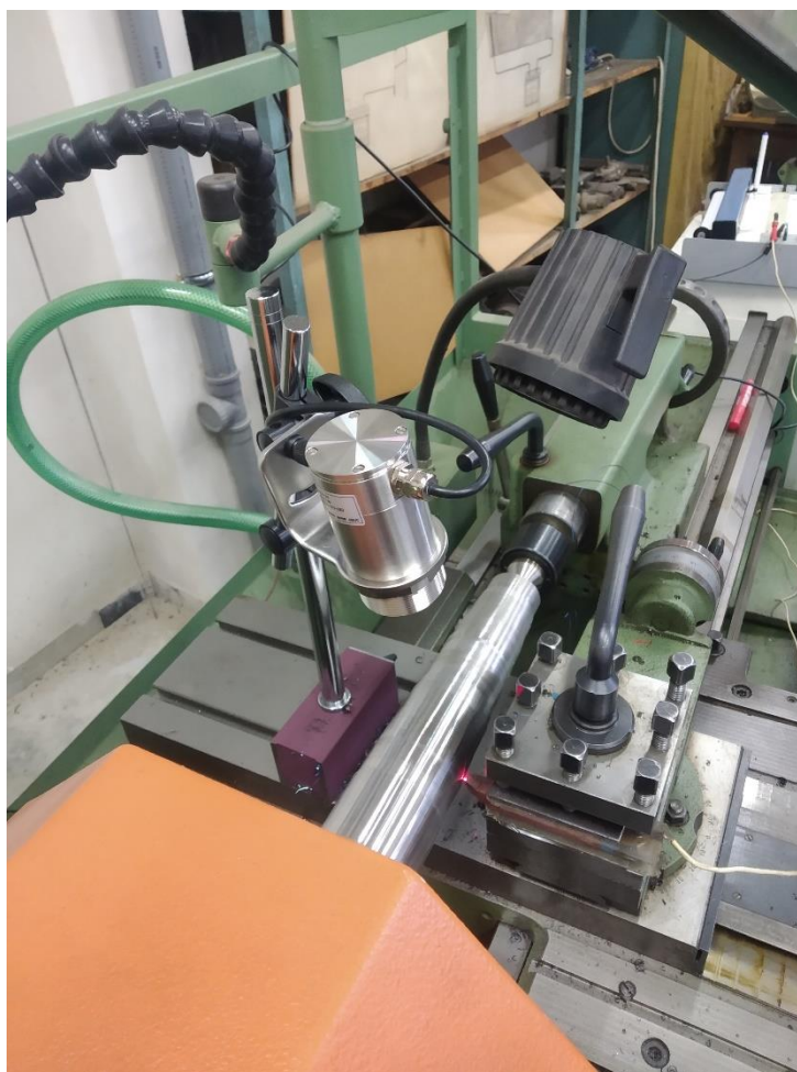
Obrázek 21 Zaměřený laser na čelo v blízkosti ostří
