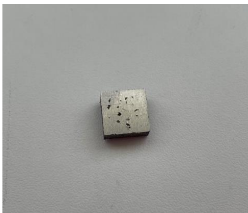
Obrázek 35 Příklad vyhodnocení: viditelná pórovitost
