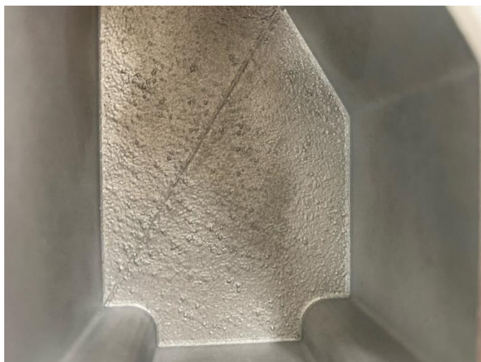
Obrázek 21 Následek poškození nanášecího břitu
