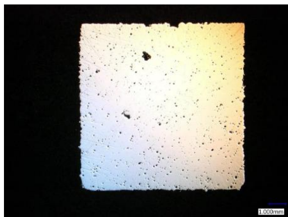
Obrázek 36 Příklad vyhodnocení: pórovitost metalografických výbrusů [29]
