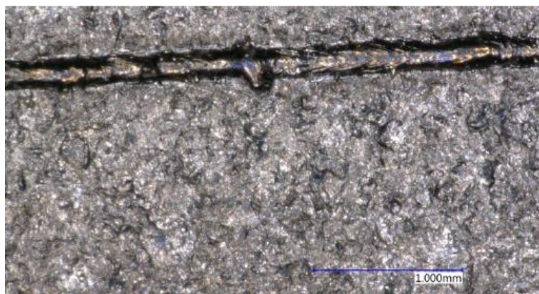
Obrázek 29 Příklad vyhodnocení: rozstřík nataveného materiálu [29]
