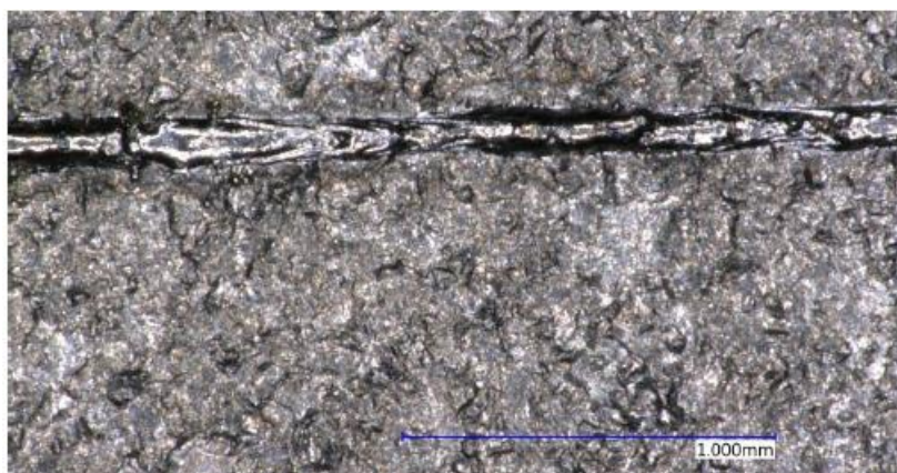
Obrázek 28 Příklad vyhodnocení: nehomogenita svaru [29]
