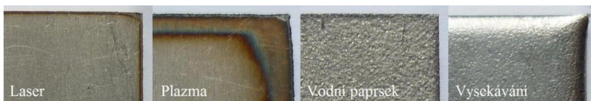
Obrázek 32 - Tepelně ovlivněná oblast po různých metodách dělení materiálu [56]
