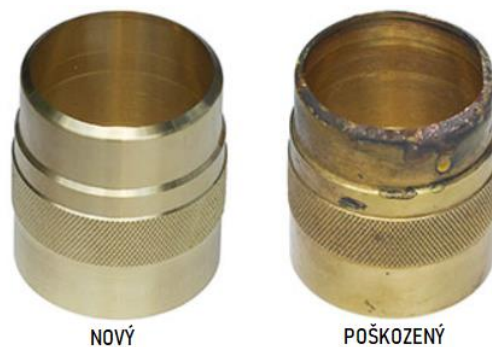
Obrázek 28 - Nový a poškozený ochranný kryt [18]
