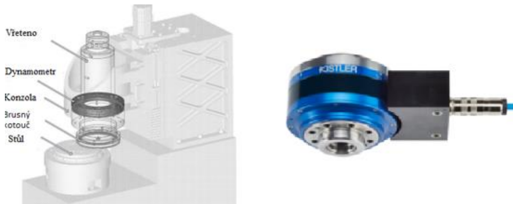
Obr. 23: Schéma měření pomocí rotačního piezoelektrického dynamometru (vlevo) [28] a piezoelektrický dynamometr firmy Kistler typu 9171A [29].
