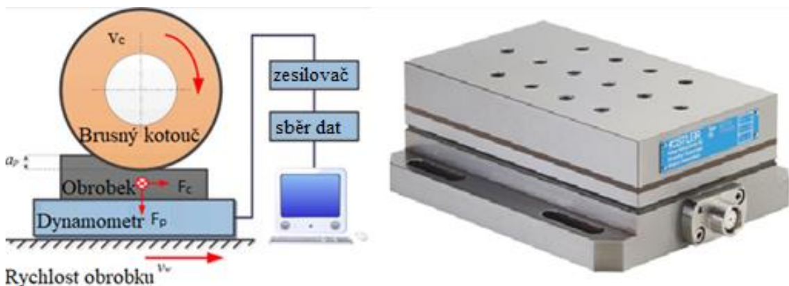
Obr. 24: Zapojení stacionárního piezoelektrického dynamometru (vlevo) [27] a piezoelektrický dynamometr typu 9257B firmy KISTLER (vpravo) [30].
