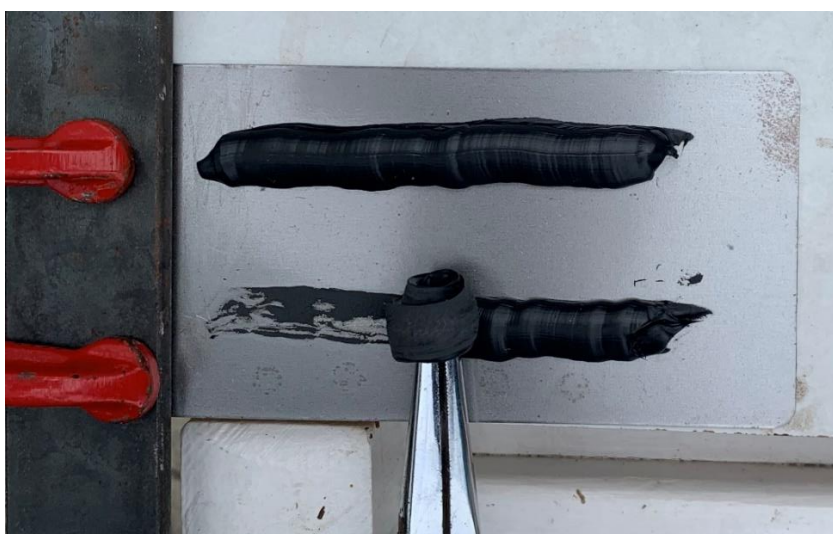
Obrázek 6 Provedení housenkové zkoušky
