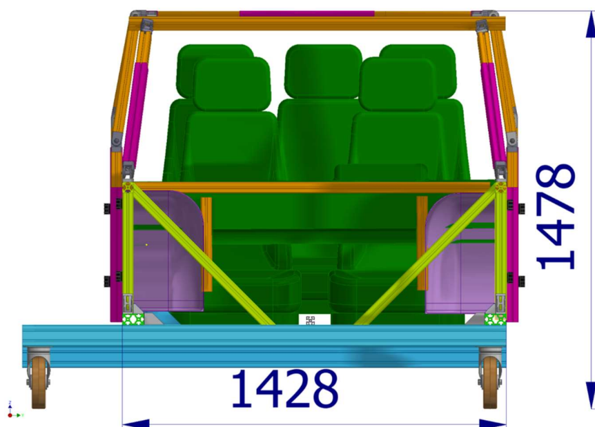
Obrázek 78: Nastavení univerzálního nosiče na rozměry vozidla Škoda Citigo, pohled v rovině YZ
