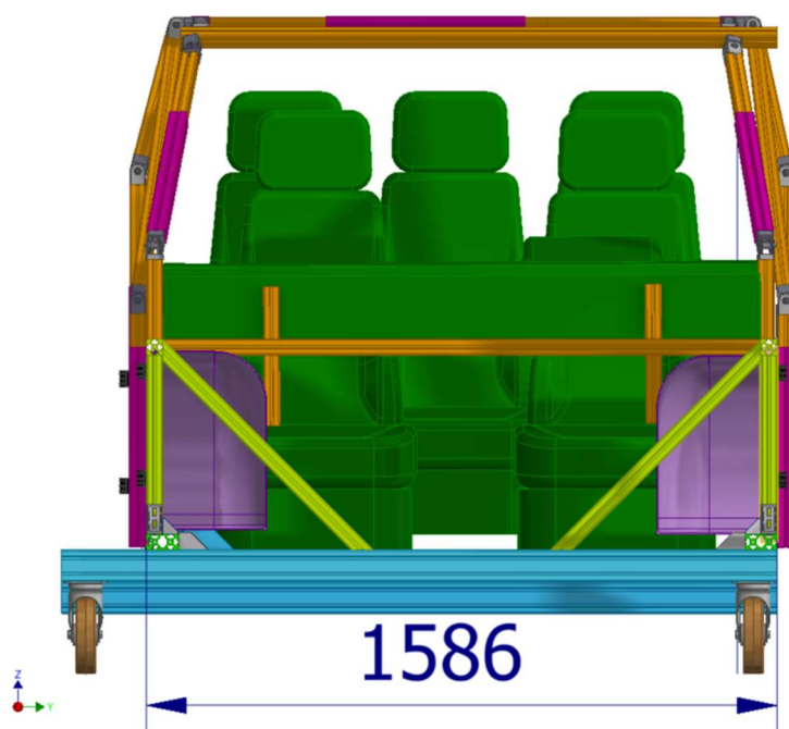
Obrázek 82: Nastavení univerzálního nosiče na rozměry vozidla Škoda Kodiaq, pohled v rovině YZ
