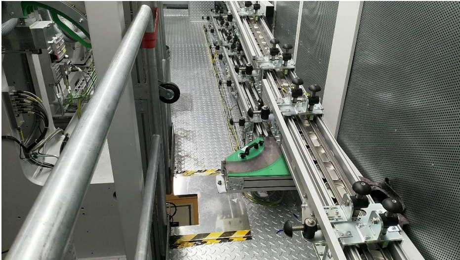
Obr. 35: Doprava hliníkových obalů kosmetických přípravků [Autor]
