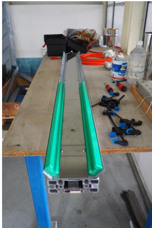
Obr. 58: Stavba měřícího přípravku – montáž kluzných plastů [Autor]
