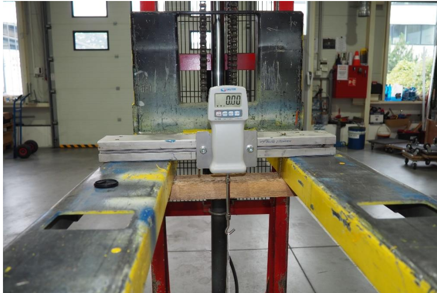
Obr. 61: Již existující přípravek pro připevnění měřícího přístroje [Autor]
