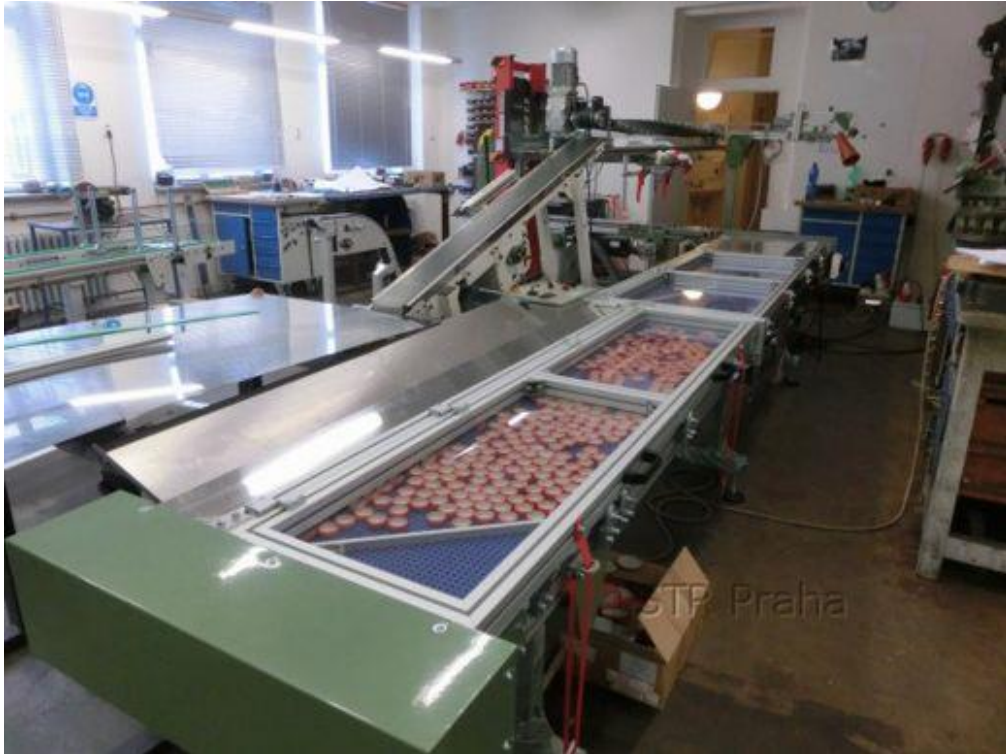
Obr. 15: Modulární dopravník pro dopravu twist-off vík na sklenice – na konci tohoto dopravníku probíhá seřazení vík do jedné řady a poté přeprava na magnetickém pásovém dopravníku dále do výroby, přičemž při seřazování modulární pás klouže pod víky, díky jeho odolnosti a vysoké kluznosti se není pás ani víka. [1]
