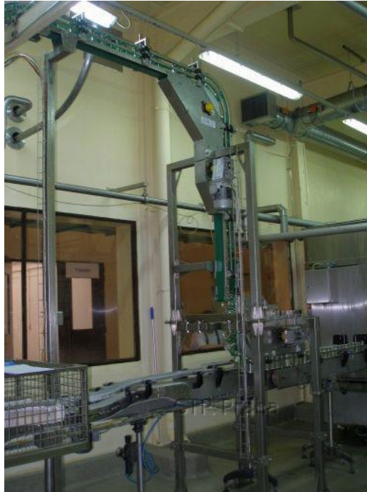
Obr. 27: Řetězový dopravník na pláště v nerezovém provedení pro potravinářskou výrobu [1]
