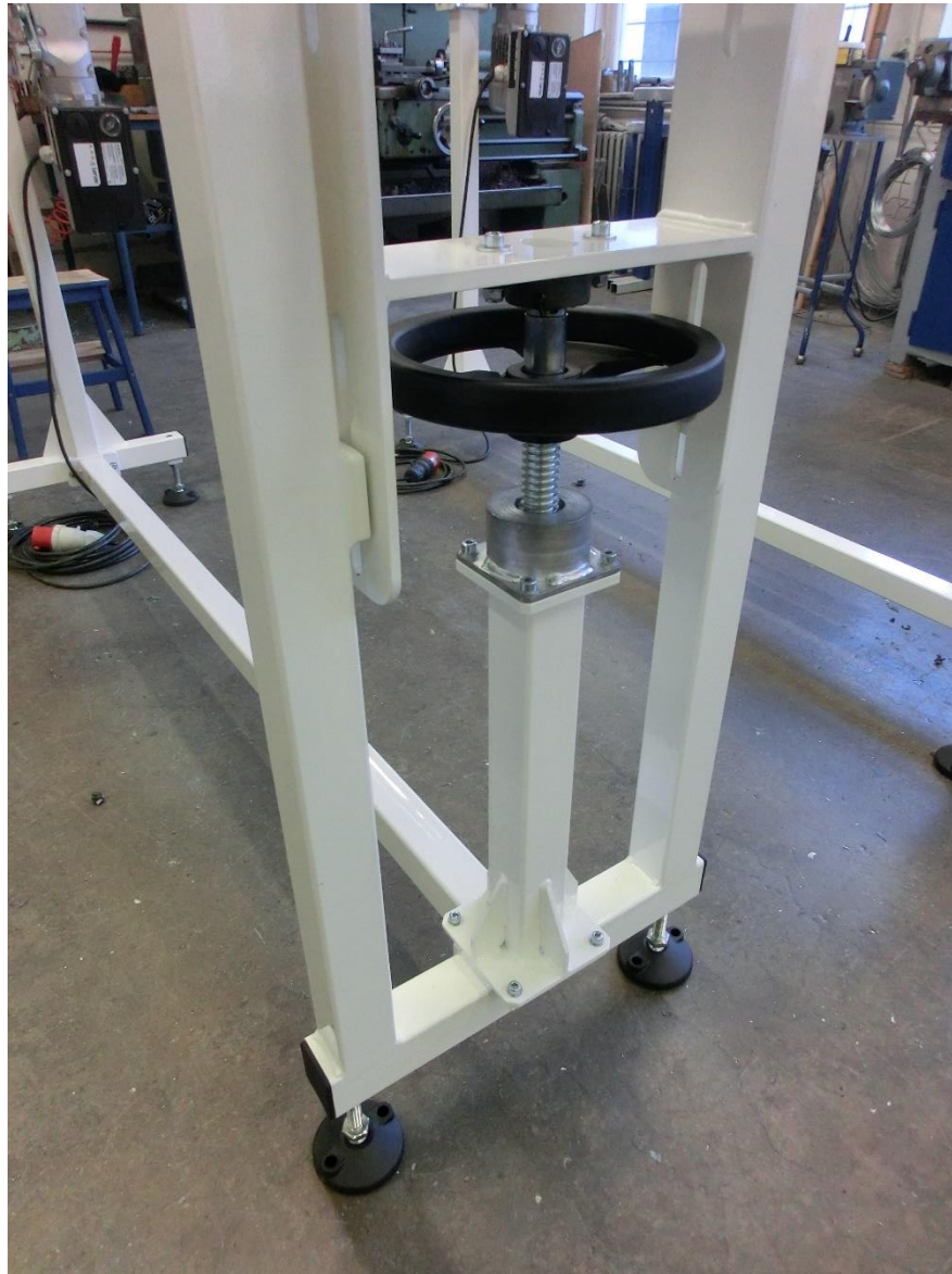
Obr. 47: Zdvhací mechanismus řešený pomocí pohybového šroubu s ovládacím kolem [Autor]
