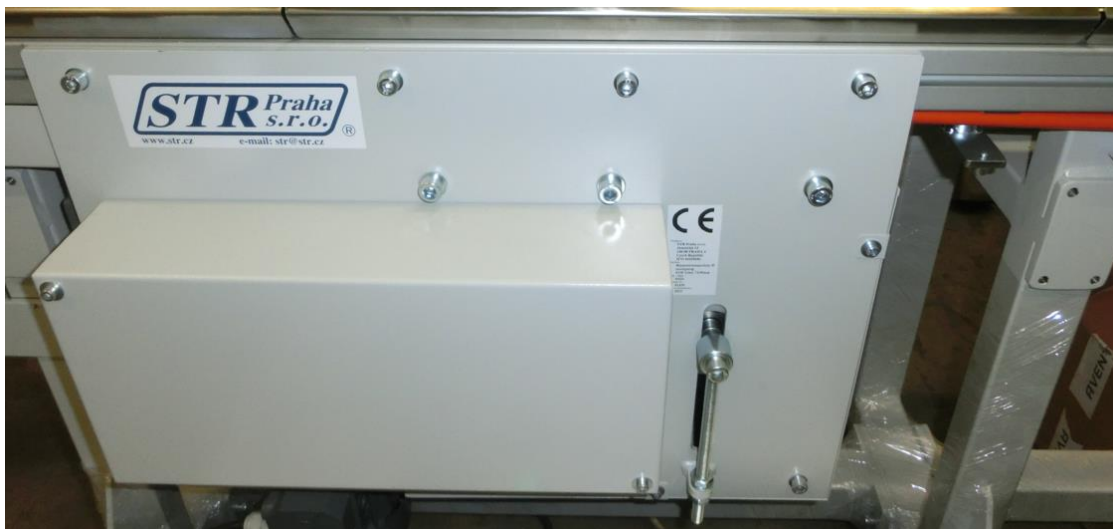
Obr. 50: Pohonná sekce pod dopravníkem – řešení pro kruhové řemínky [Autor]
