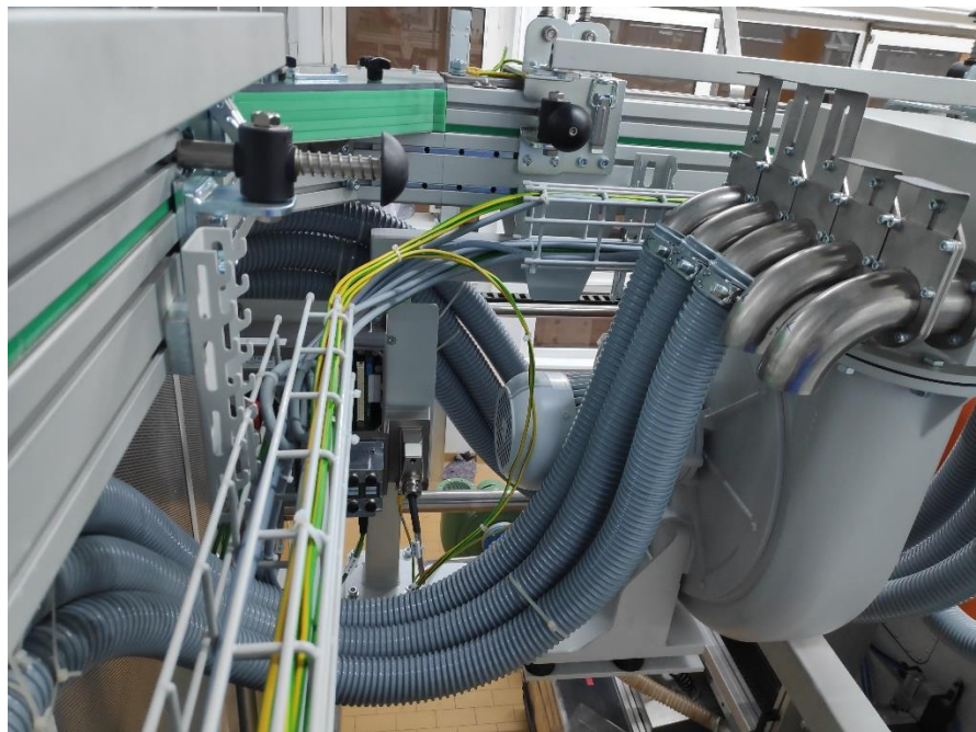
Obr. 30: Regulace množství vzduchu na výstupu z ventilátoru [Autor]
