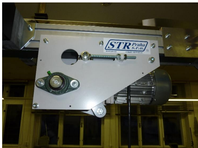
Obr. 52: Pohonná sekce pod dopravníkem – řešení pro pásový dopravník [Autor]
