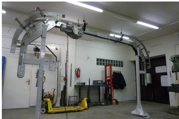
Obr. 39: Doprava pláště kbelíku uzavřeného z jedné strany pásovým dopravníkem – pohled z druhé strany [Autor]
