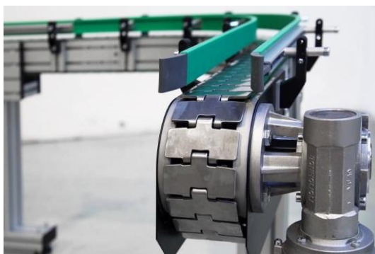
Obr. 21: destičkový dopravník z hliníkového profilu s nerezovými destičkami [9]
