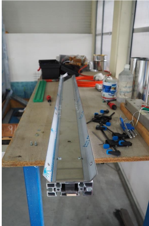
Obr. 57: Stavba měřícího přípravku – připevnění nerezových plechů k hliníkovému profilu [Autor]
