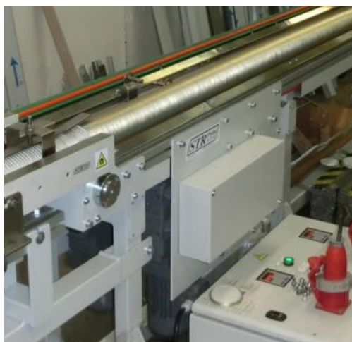
Obr. 51: Pohonná sekce pod dopravníkem – řešení pro kruhové řemínky [Autor]
