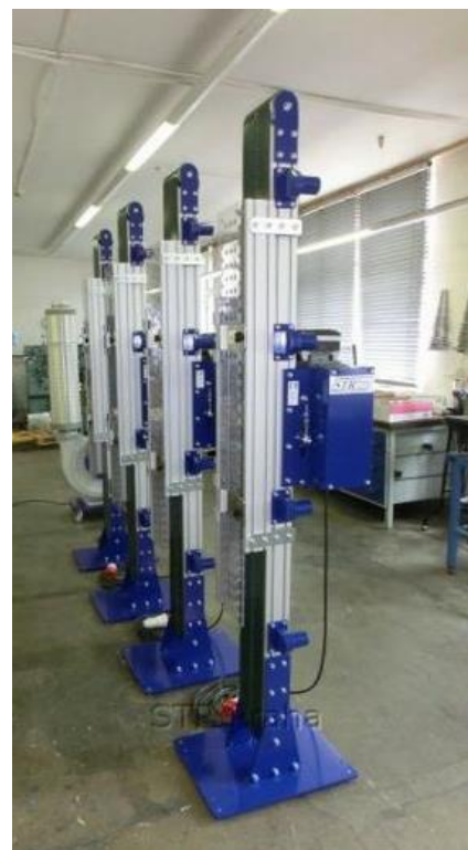
Obr. 12: Vakuový elevátor pro dna a víka [1]
