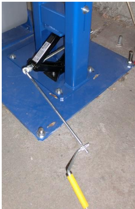
Obr. 49: Zdvihací mechanismus řešený automobilovým nůžkovým zvedákem [Autor]
