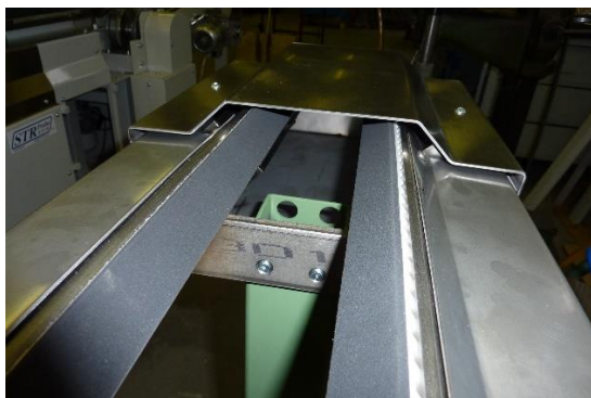
Obr. 44: Pohled na koncový hnací mechanismus řemenového dopravníku [Autor]
