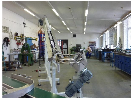
Obr. 43: Celkový pohled na řemenový dopravník pro dopravu papírových vík ve stohu [Autor]
