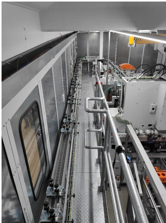
Obr. 36: Doprava hliníkových obalů kosmetických přípravků [Autor]
