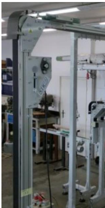
Obr. 11: Magnetický elevátor s navazujícím horizontálním dopravníkem [1]
