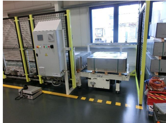
Obr. 25: Vykládací prostor automatizovaného řetězového dopravníku pro palety s hmotností do 3,5 [t] [Autor]
