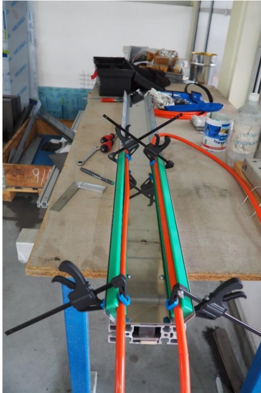
Obr. 59: Stavba měřicího přípravku – upevnění kruhových řemínků [Autor]
