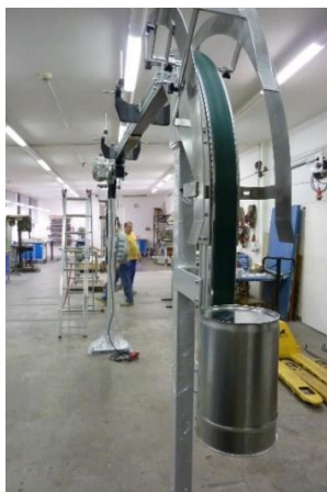
Obr. 38: Doprava pláště kbelíku uzavřeného z jedné strany pásovým dopravníkem [Autor]
