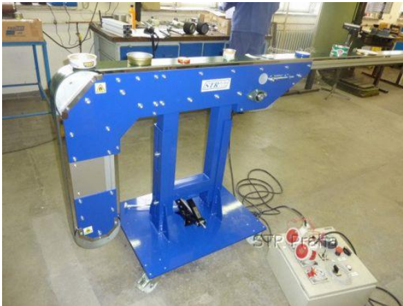
Obr. 8: Doprava různých druhů plechovek na magnetickém pásovém dopravníku [1]
