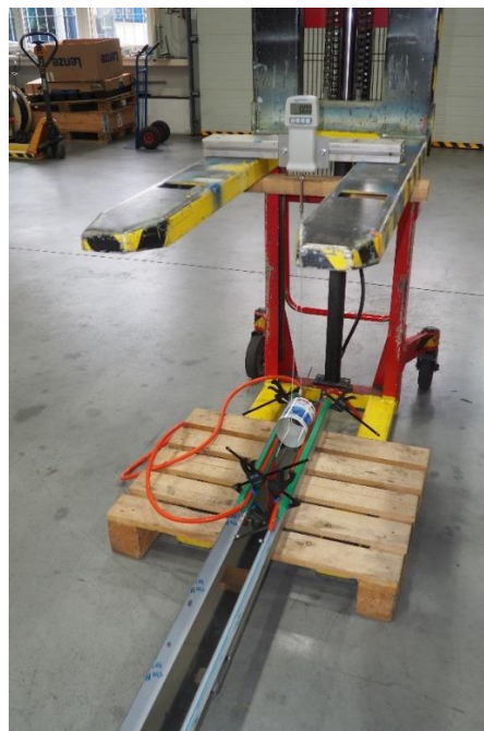
Obr. 60: Stavba měřicího přípravku – umístění měřicího přípravku na hydraulický vysokozdvizný vozík [Autor]
