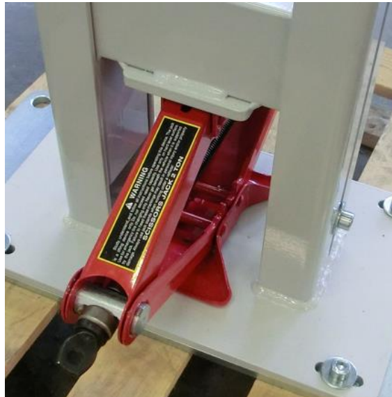
Obr. 48: Zdvihací mechanismus řešený automobilovým nůžkovým zvedákem [Autor]
